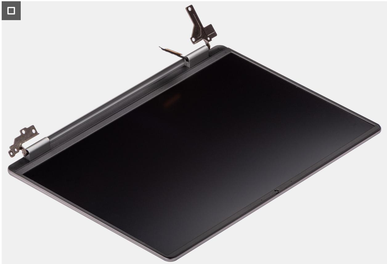
**Ilustración 44. Ensamblaje de la pantalla**
