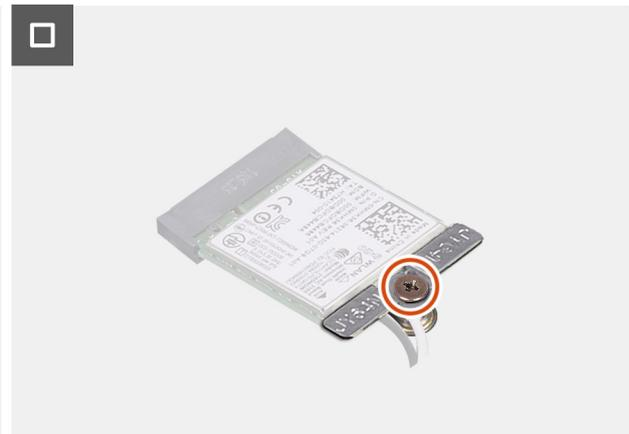
**Ilustración 18. Instalación de la tarjeta inalámbrica**
