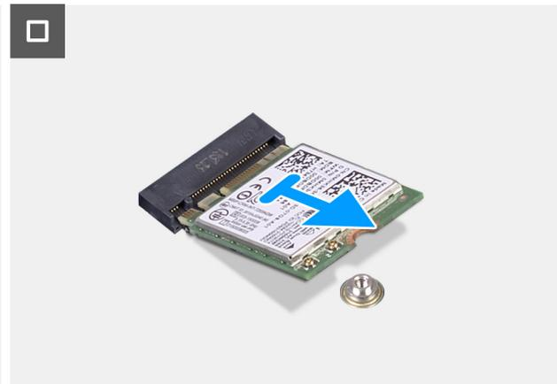
Ilustración 17. Extracción de la tarjeta inalámbrica
