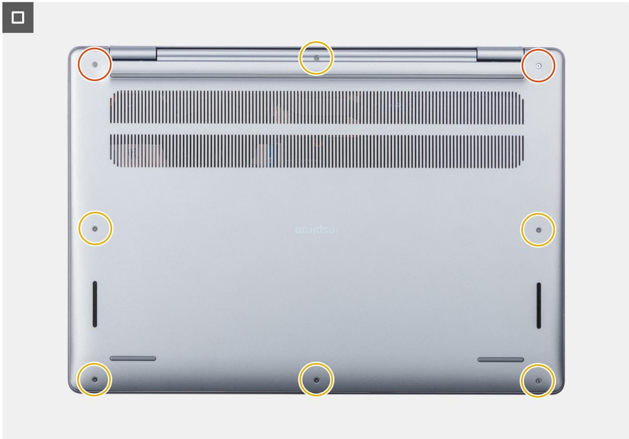
**Ilustración 12. Instalación de la cubierta de la base**
