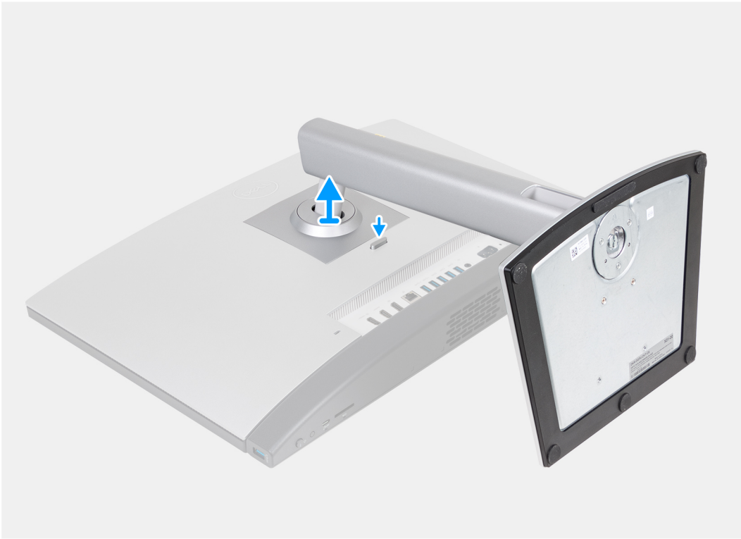
Ilustración 18. Extracción de la base de altura regulable (HAS)
