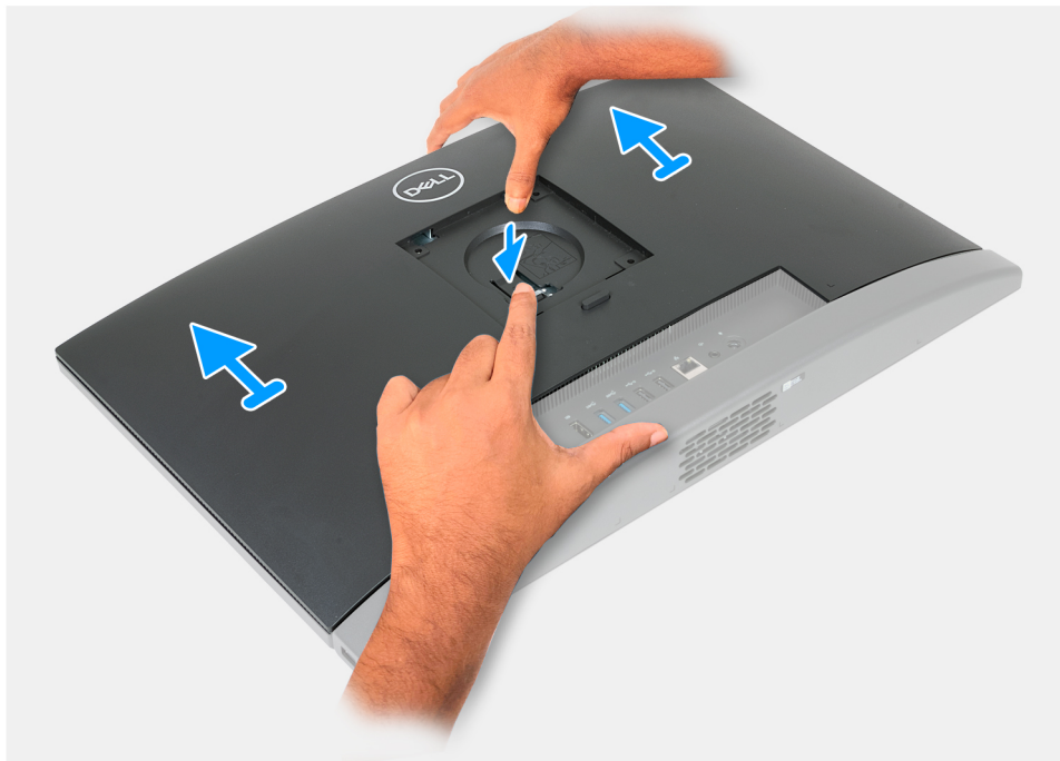
Ilustración 82. Extracción de la cubierta posterior
