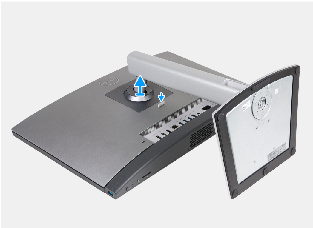
Ilustración 79. Extracción de la base
