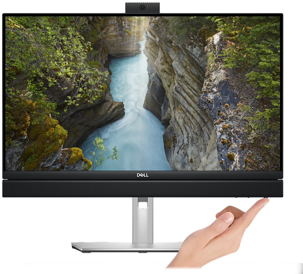
Ilustración 14. Presione el botón de encendido
