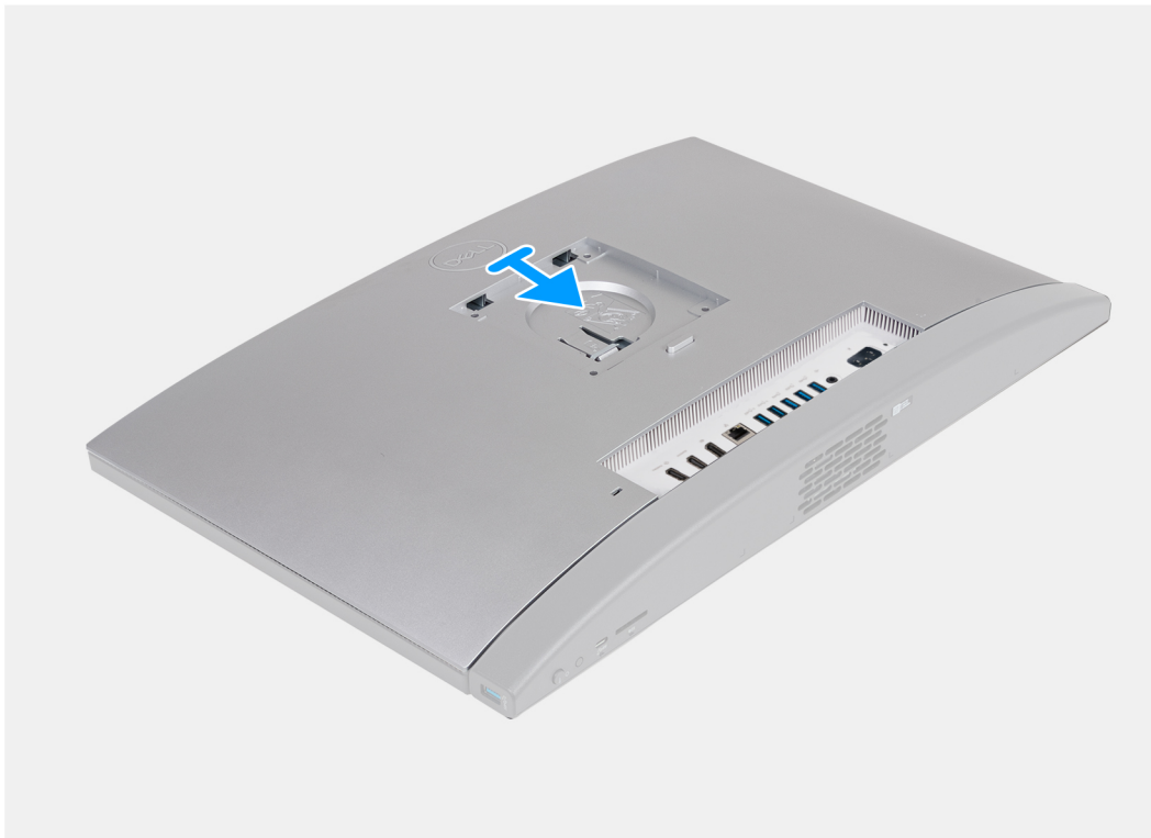
Ilustración 23. Instalación de la cubierta posterior
