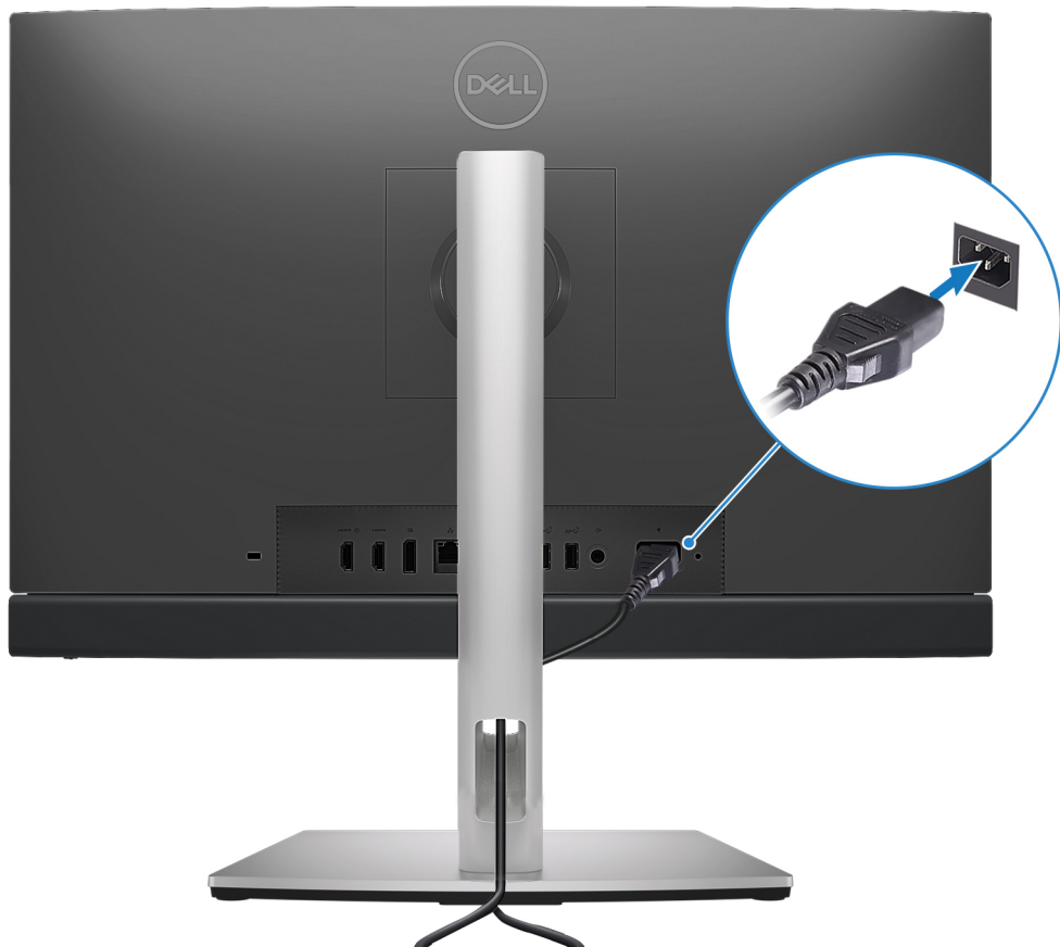
Ilustración 13. Conexión del cable de alimentación
