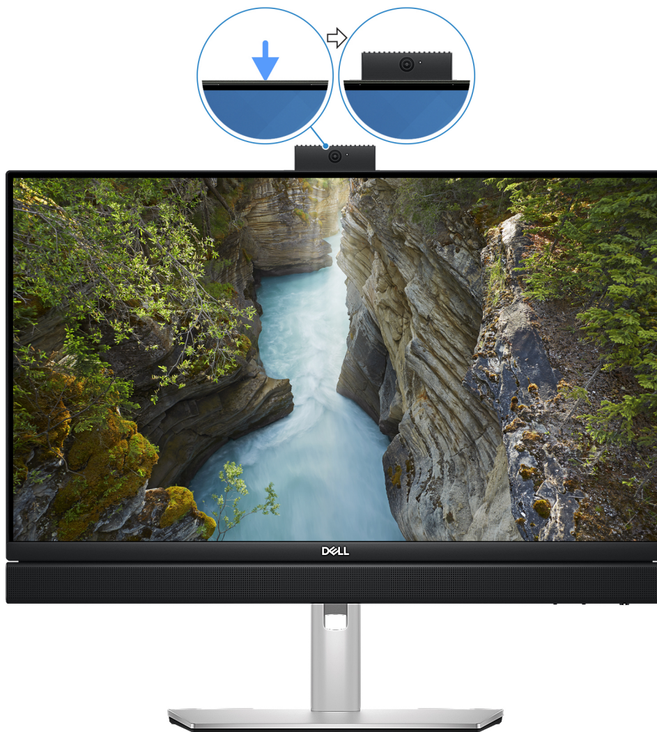
Ilustración 4. Localización de la cámara retráctil
