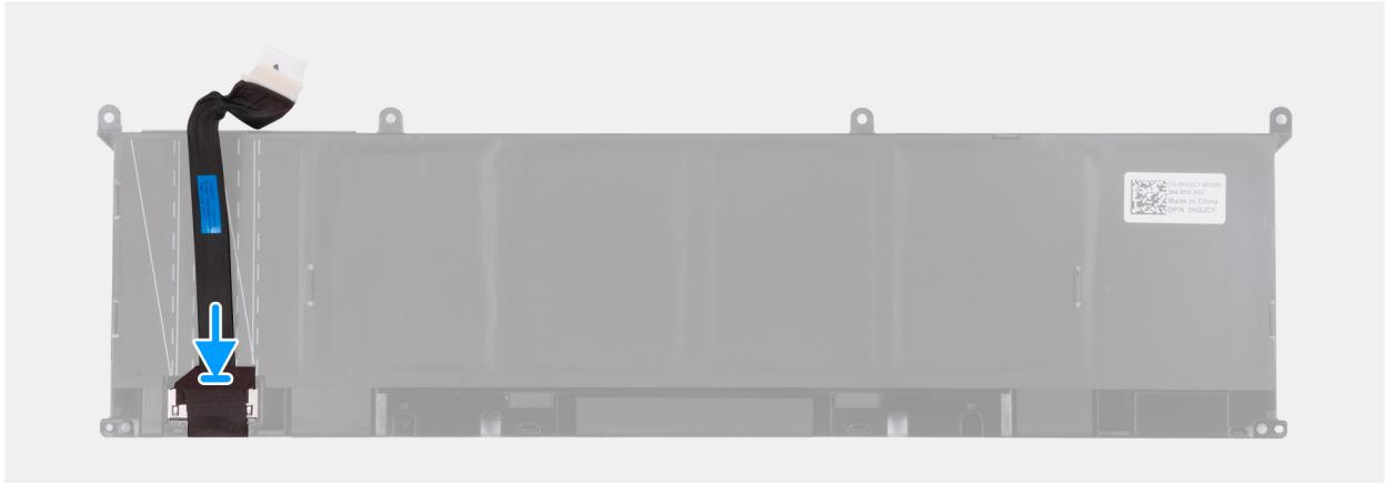
Rysunek 28. Instalowanie kabla baterii 90 Wh
