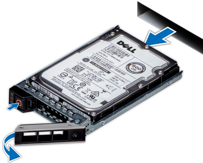
Abbildung 73. Entfernen eines Festplattenträgers
