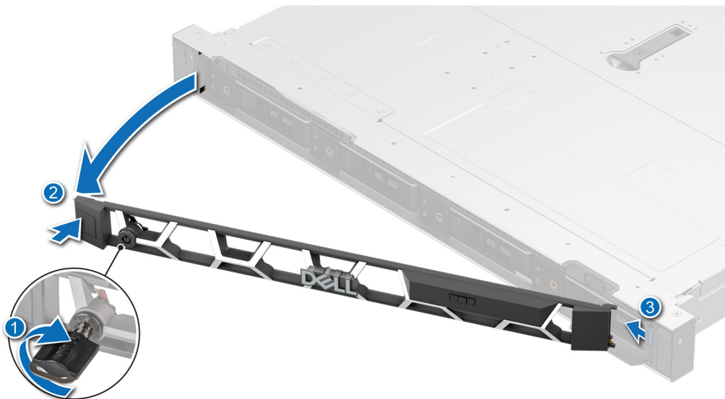
Abbildung 57. Entfernen der Frontverkleidung mit LCD-Bedienfeld
