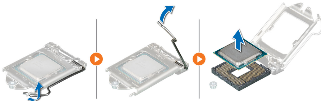
Abbildung 45. Entfernen des Prozessors
