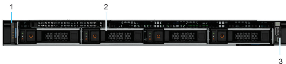
Abbildung 1. Frontansicht eines Systems mit 4 x 3,5-Zoll-Laufwerken
