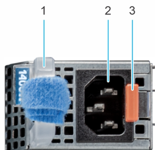
Abbildung 12. Auf der Vorderseite zugängliche Konfiguration – Statusanzeige des Wechselstromnetzteils
