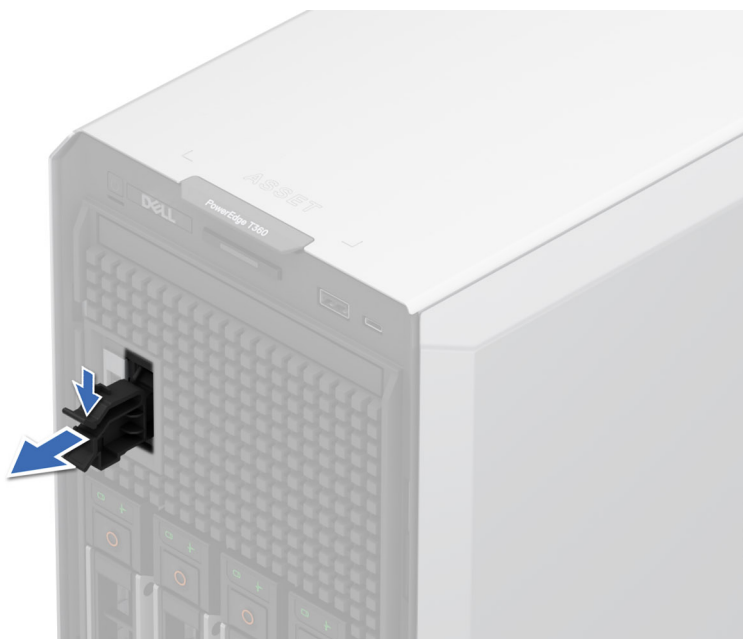
Abbildung 99. Entfernen des Platzhalters für das BOSS-N1-Modul
