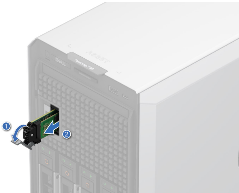
Abbildung 70. Entfernen des BOSS-N1-Kartenträgers
