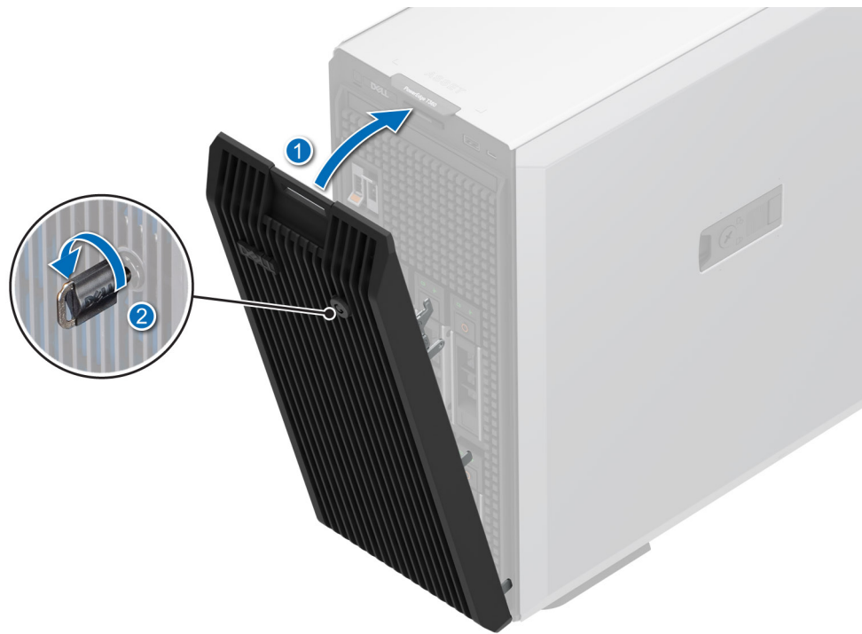
Abbildung 13. Installieren der Frontverkleidung
