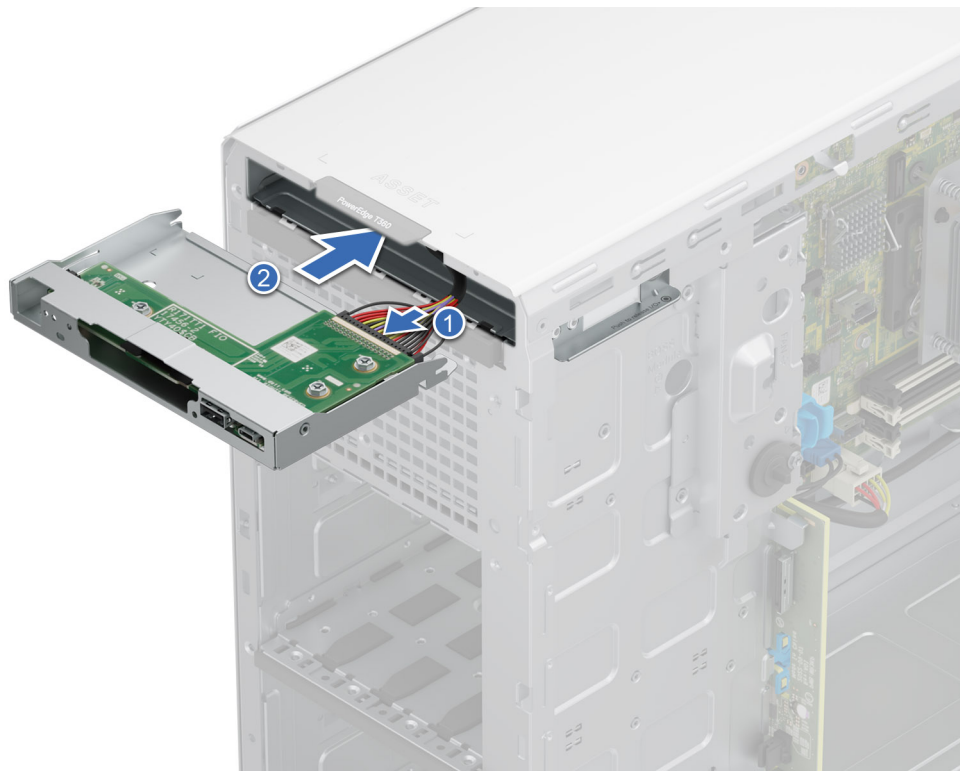
Abbildung 96. Installieren des Bedienfeldgehäuses
