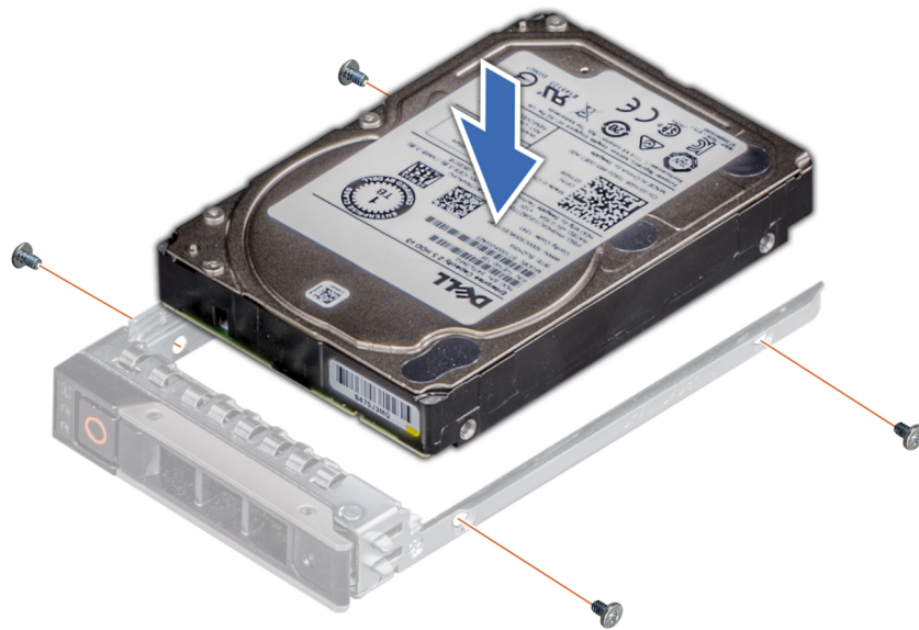
Abbildung 29. Einsetzen eines Laufwerks in den Laufwerksträger
