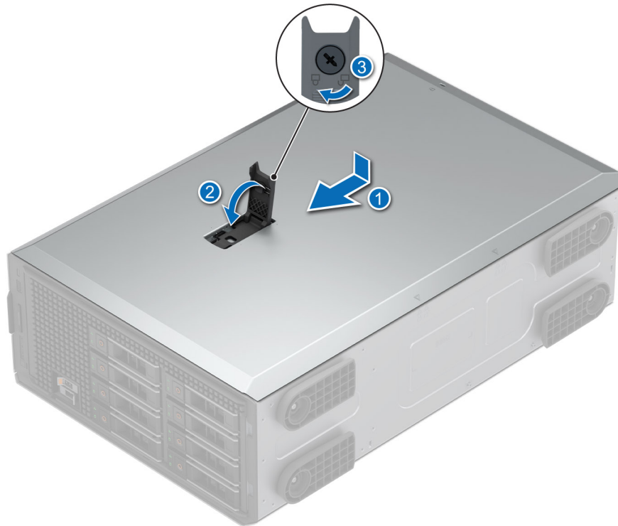
Abbildung 17. Installieren der Systemabdeckung
