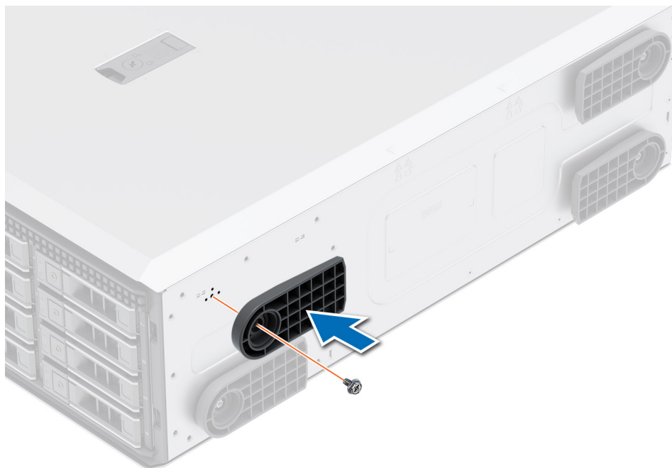
Abbildung 15. Installieren der Systemstandfüße
