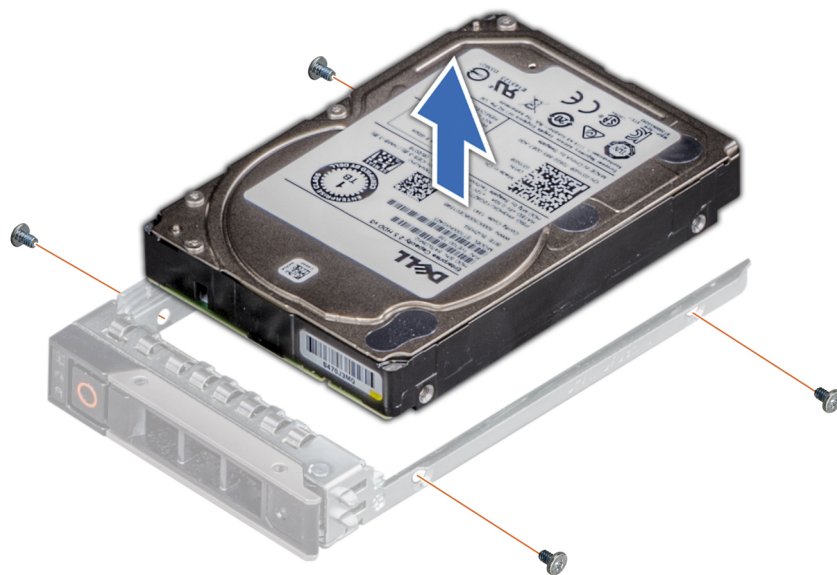
Abbildung 28. Laufwerk aus Laufwerkträger entfernen
