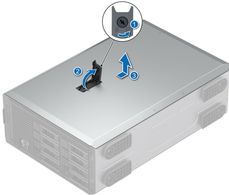
Abbildung 16. Entfernen der Systemabdeckung
