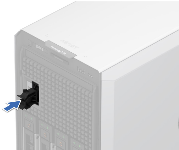
Abbildung 72. Installieren des Platzhalters für den BOSS-N1-Kartenträger
