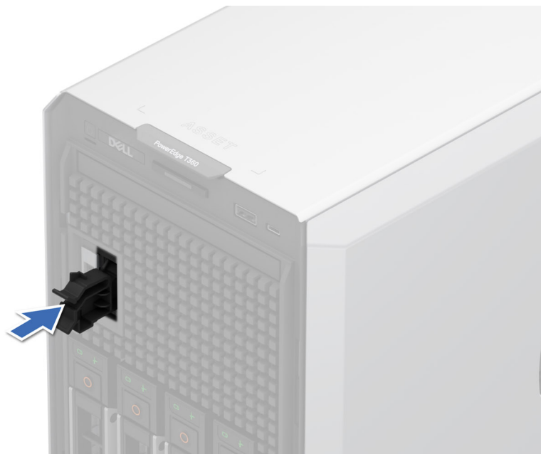
Abbildung 67. Installieren des Platzhalters für das BOSS-N1-Modul
