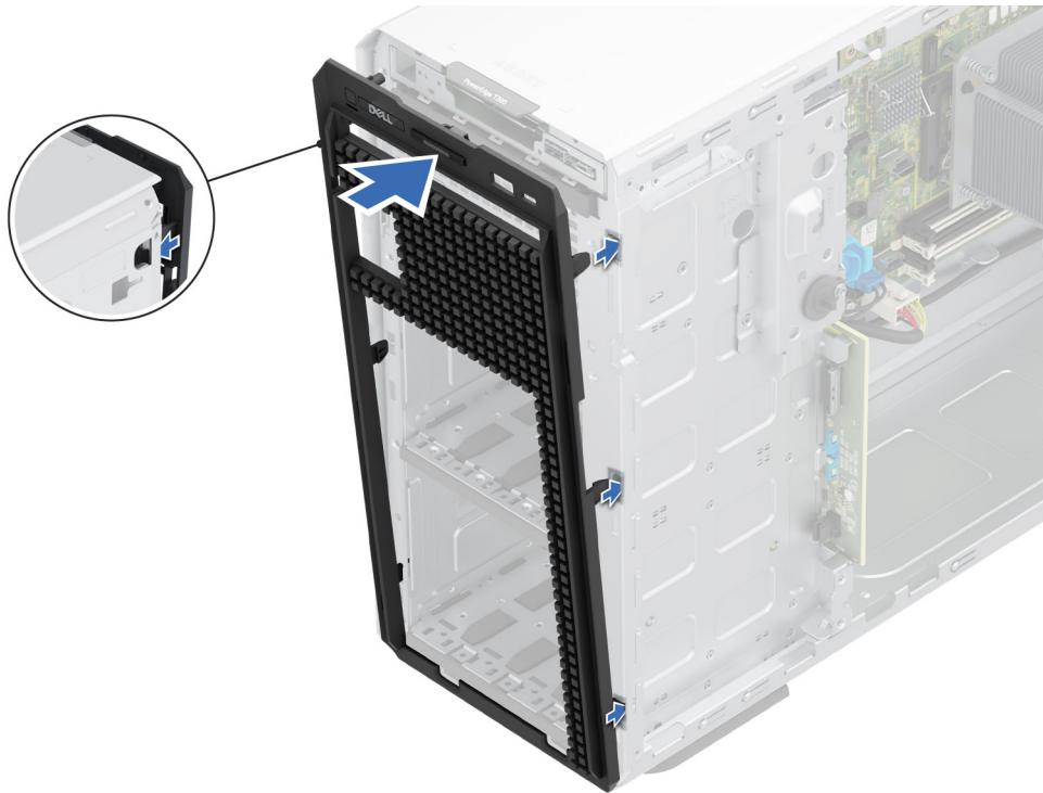
Abbildung 97. Anbringen der vorderen Abdeckplatte
