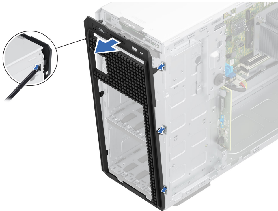
Abbildung 92. Entfernen der vorderen Abdeckplatte
