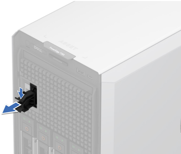
Abbildung 73. Entfernen des Platzhalters für den BOSS-N1-Kartenträger
