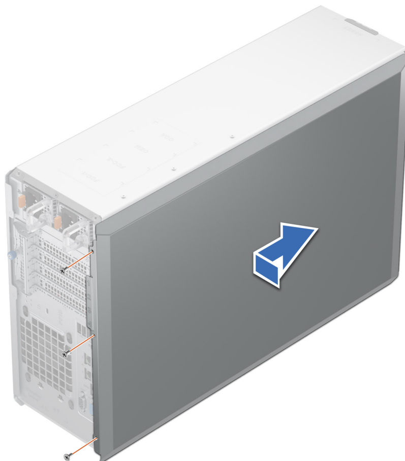
Abbildung 98. Installieren der Seitenabdeckung des Systems
