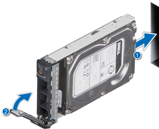
Abbildung 27. Installieren eines Laufwerksträgers
