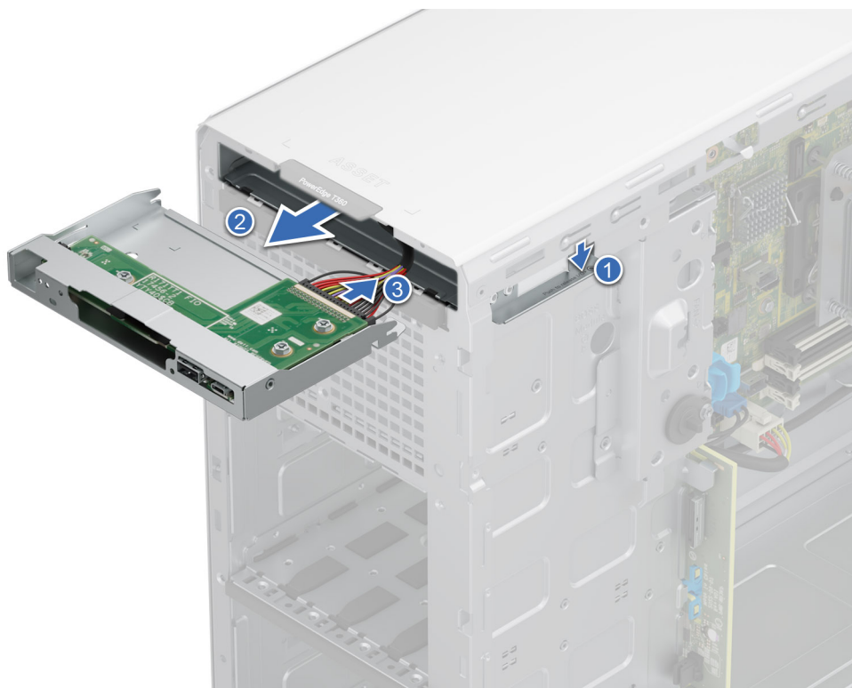
Abbildung 93. Entfernen des Bedienfeldgehäuses
