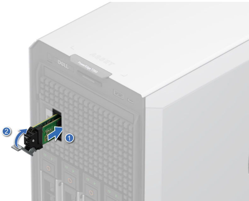
Abbildung 75. Installieren des BOSS-N1-Kartenträgers
