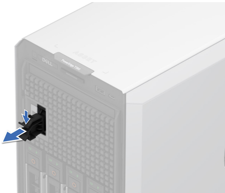
Abbildung 68. Entfernen des Platzhalters für das BOSS-N1-Modul
