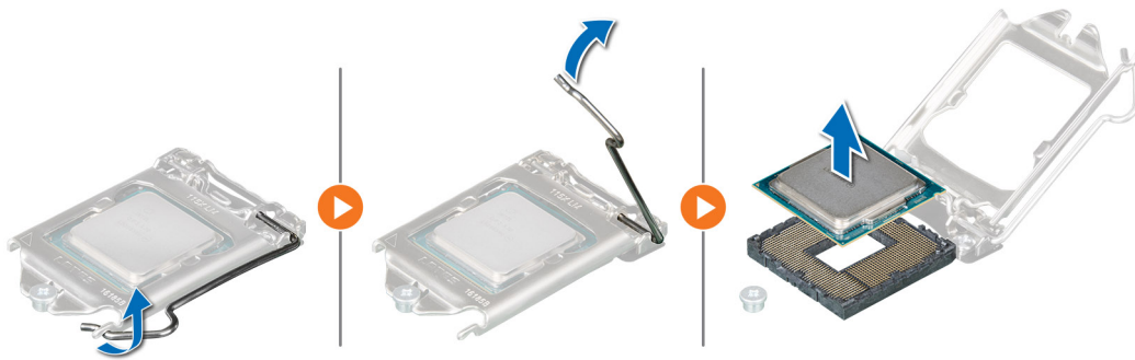
Figure 53. Retrait du processeur
