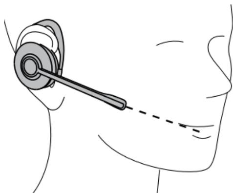
4. Vergewissere dich, dass der EarHook ohne Zwischenraum an der Rückseite deines Ohrs anliegt. Passe den EarHook bei Bedarf noch etwas an.
