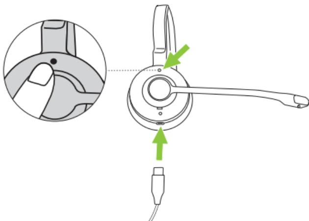
3. Das Headset kann nun als Audio-Wiedergabegerät auf dem Computer ausgewählt werden. Während der Verbindung des Headsets über das USB-Kabel sind die Headset-Funktionen „Anrufsteuerung“ und „Busylight“ nicht unterstützt.
