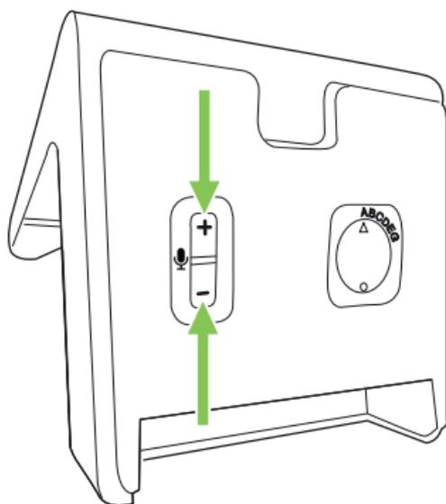
Zur Einstellung der Mikrofonlautstärke drücken Sie die Tasten  $+$  oder  $-$  auf der Unterseite der Basisstation.
