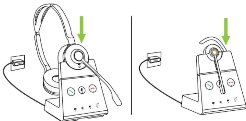
Das Headset wird stets geladen, wenn es in der Basisstation andockt und diese an eine Stromversorgung angeschlossen ist. Während des Aufladens blinkt die Status-LED am Headset und das Batteriesymbol an der Basisstation.
