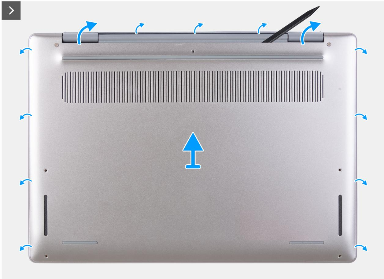
Abbildung 16. Entfernen der Bodenabdeckung
