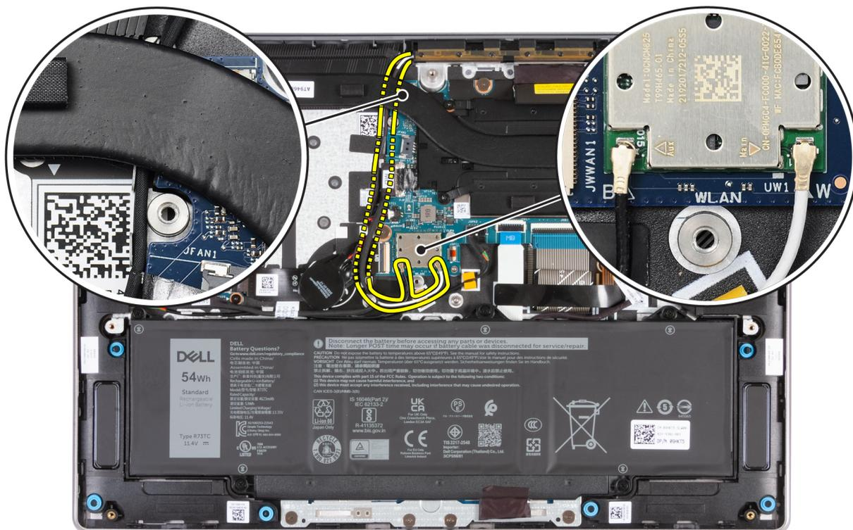
Abbildung 62. Installieren der WLAN-Antennenkabel
