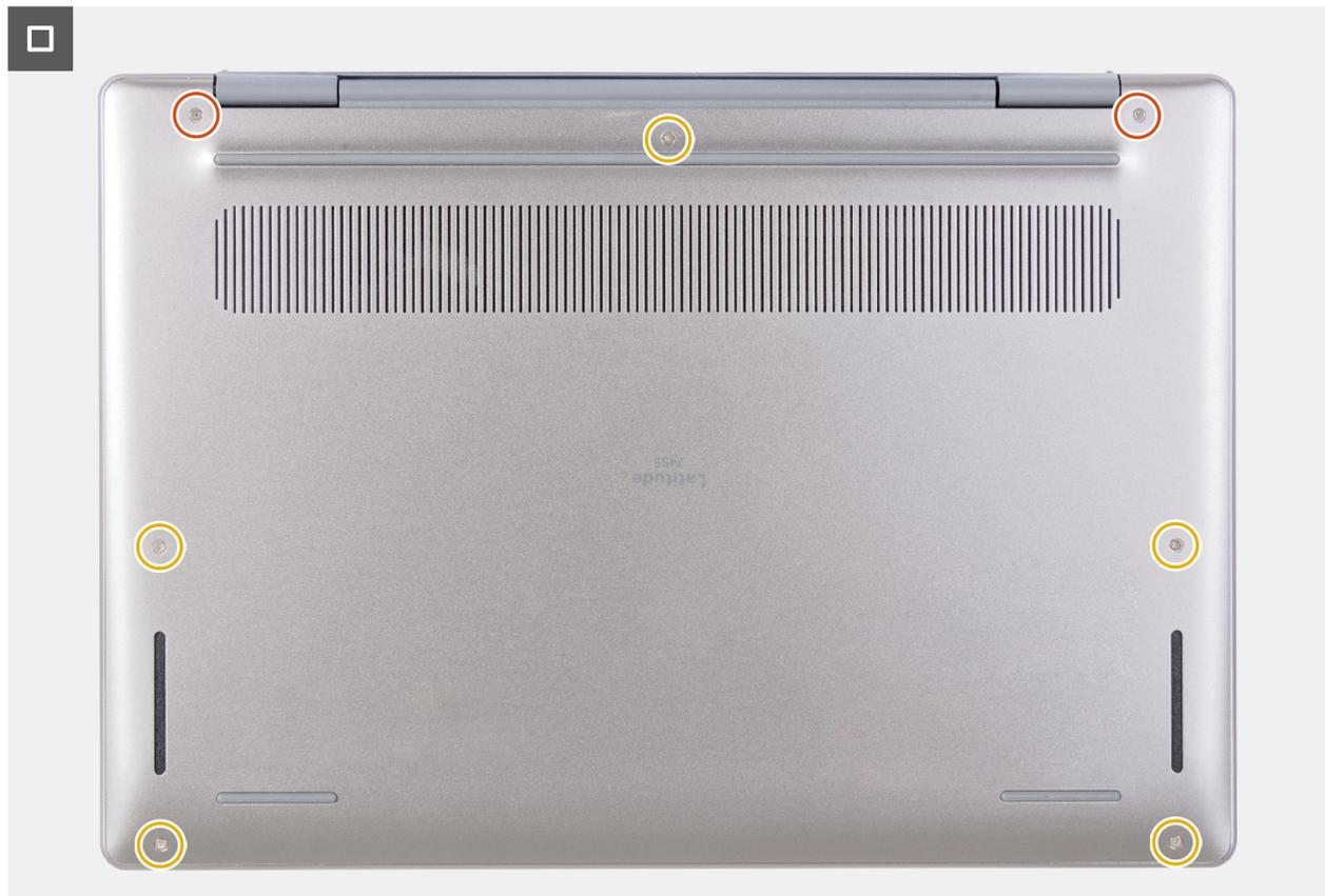
**Abbildung 20. Einsetzen und Anziehen der Schrauben**
