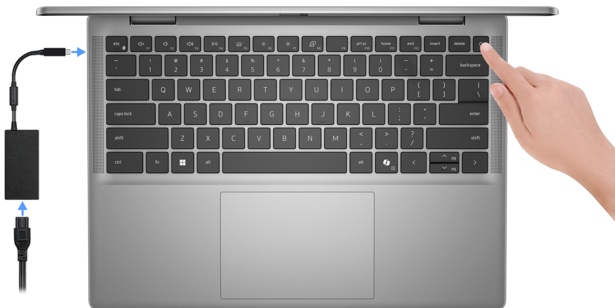
Afbeelding 7. Sluit de voedingsadapter aan en druk op de aan-uitknop.
