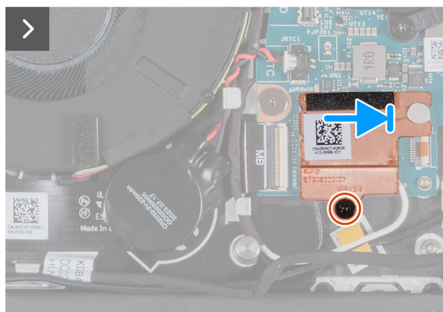
Afbeelding 57. De FPC-kabel van de I/O-kaart plaatsen
