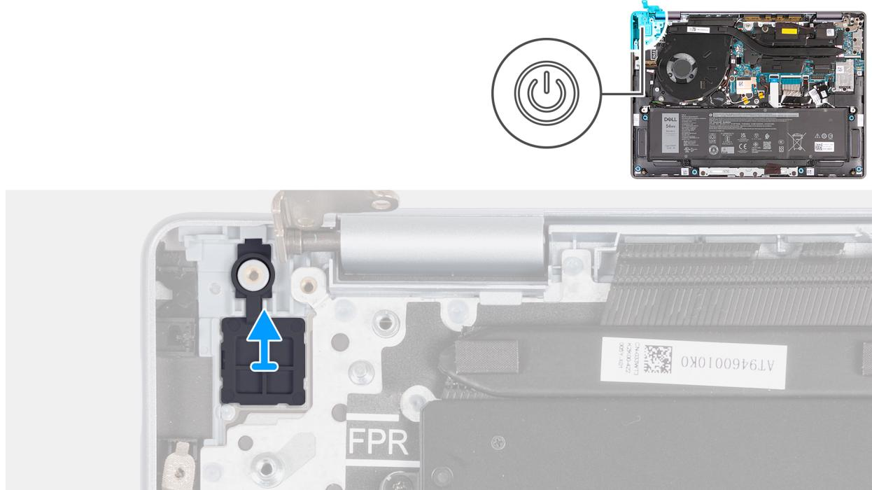
Obrázek 88. Demontáž vypínače
