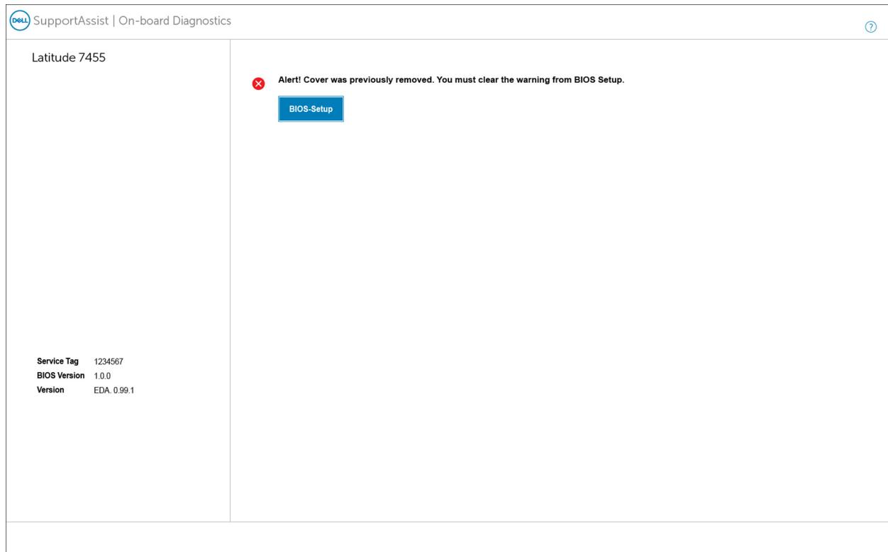
Obrázek 103. Vymazání upozornění při vniknutí do šasi
