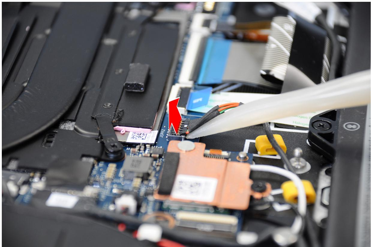
Obrázek 32. Uvolnění kabelu reproduktoru z konektoru
