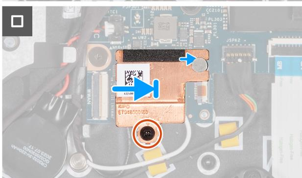
**Obrázek 61. Montáž modulu antény WLAN (pro počítače dodávané pouze s podporou sítě WLAN)**
