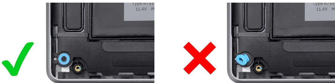
Obrázek 34. Montáž pryžových průchodek
