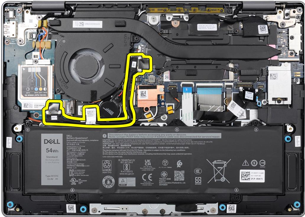
**Obrázek 52. Umístění kabelu desky I/O**
