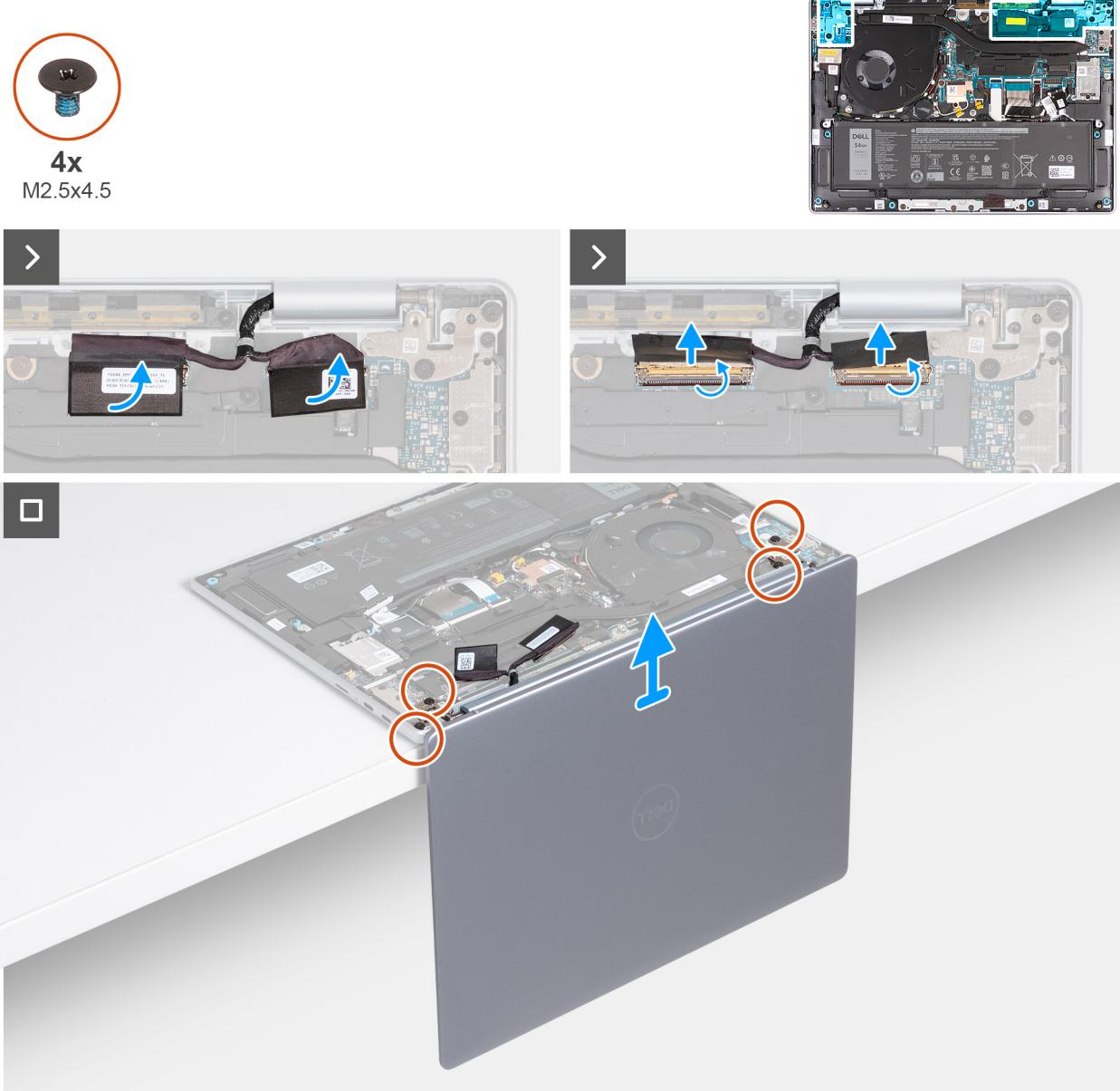
**Obrázek 74. Demontáž sestavy displeje (pro počítače dodávané pouze s podporou sítě WLAN)**
