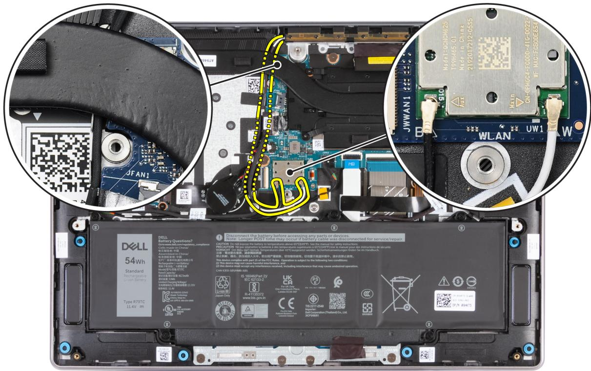
**Obrázek 71. Montáž kabelů antény WLAN**
