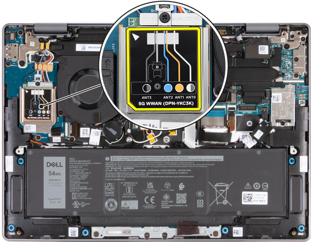
**Obrázek 29. Připojení kabelů antény**
