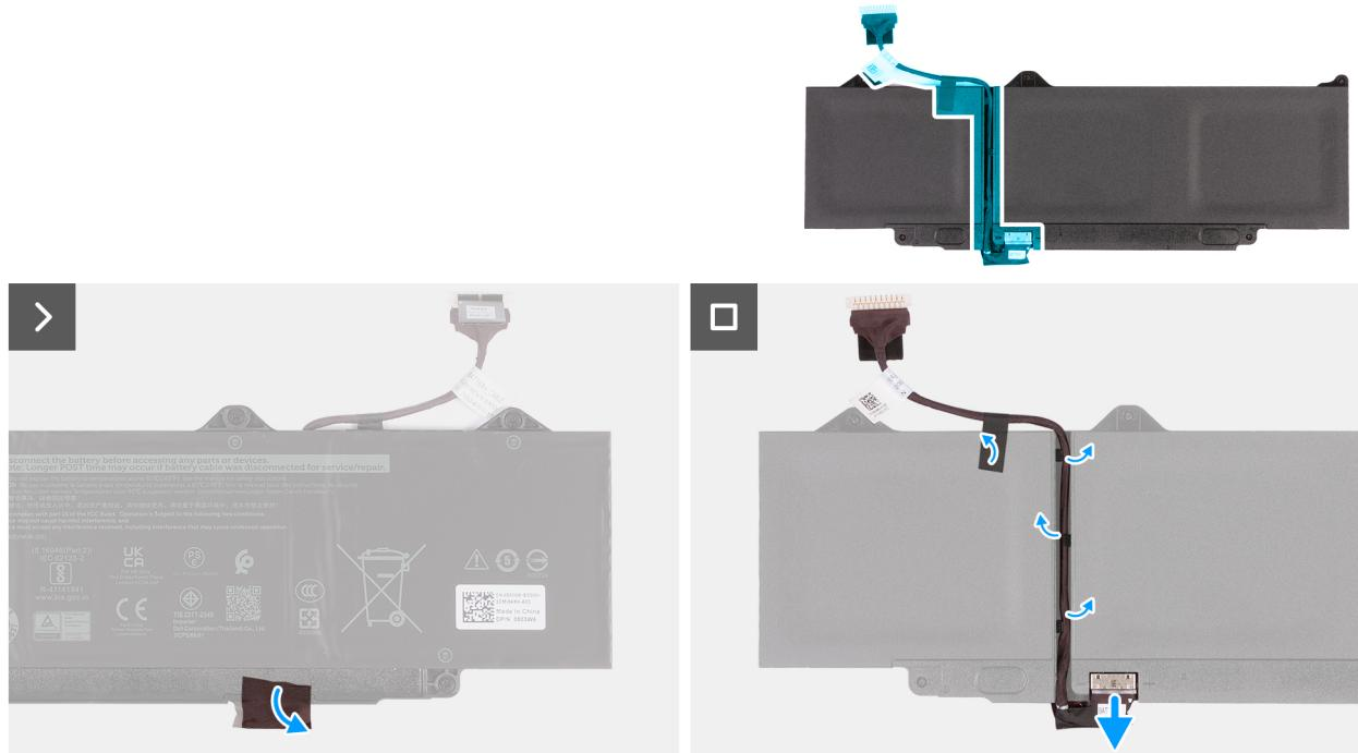
**Obrázek 41. Demontáž kabelu baterie**
