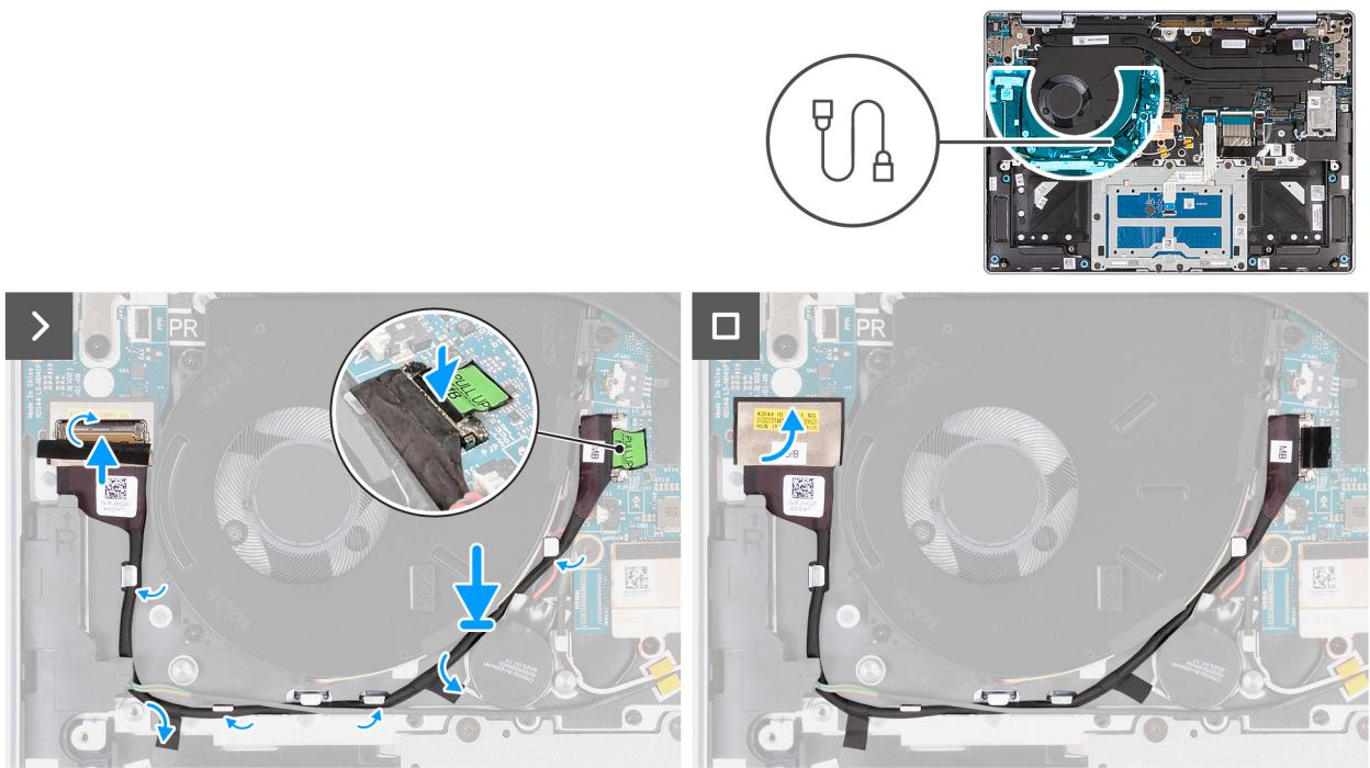
**Obrázek 51. Montáž kabelu desky I/O (pro počítače dodávané pouze s podporou sítě WLAN)**
