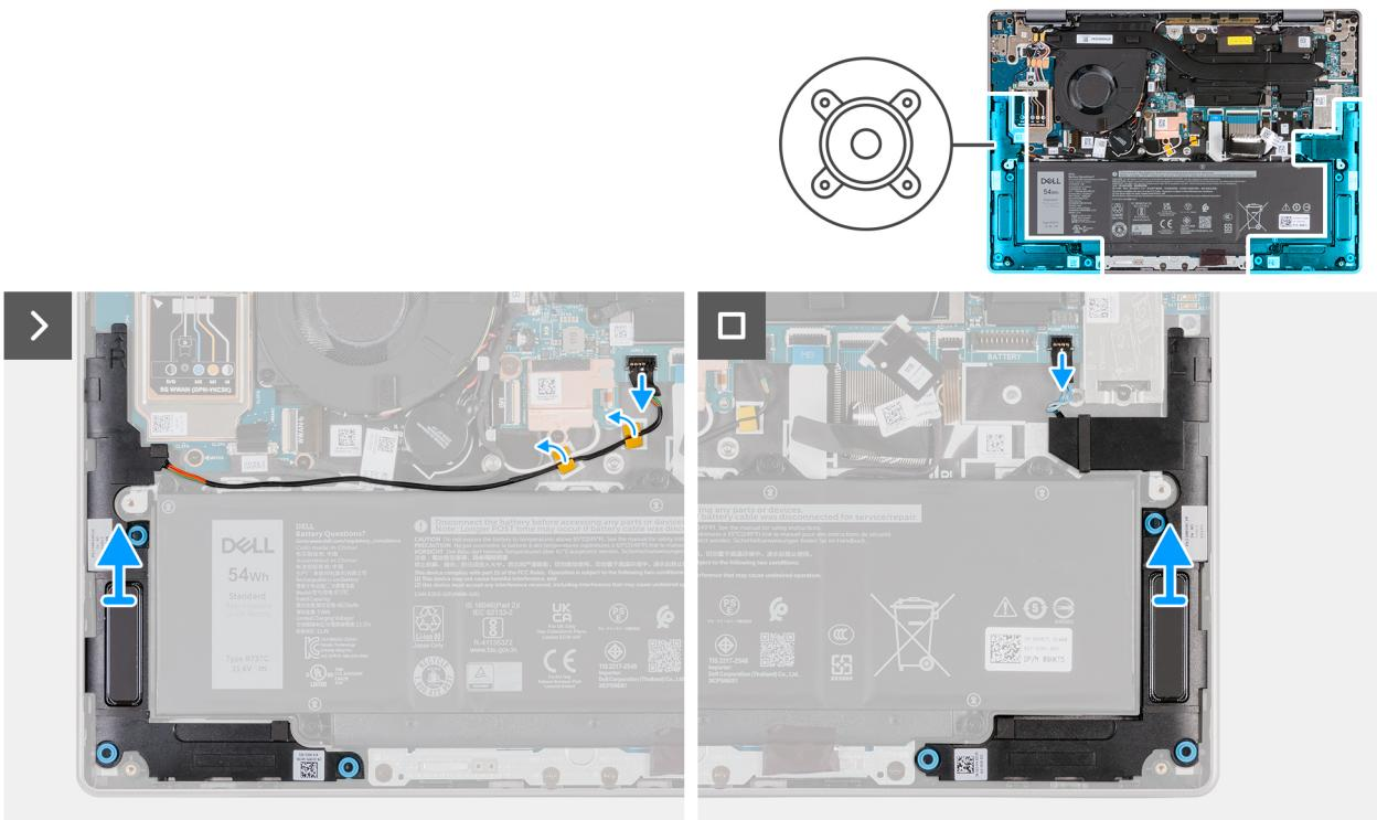
**Obrázek 31. Demontáž reproduktoru**
