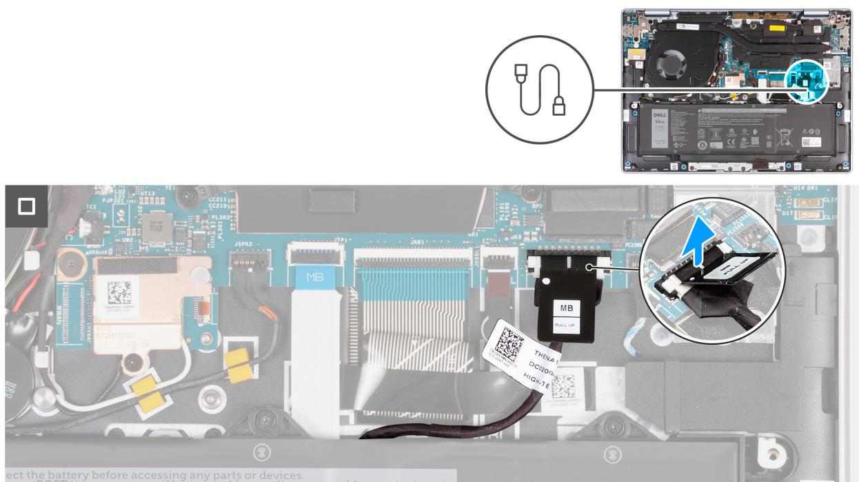
Obrázek 17. Odpolení kabelu baterie
