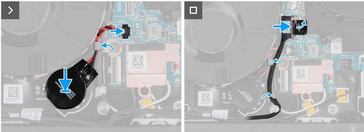
Obrázek 47. Montáž knoflíkové baterie
