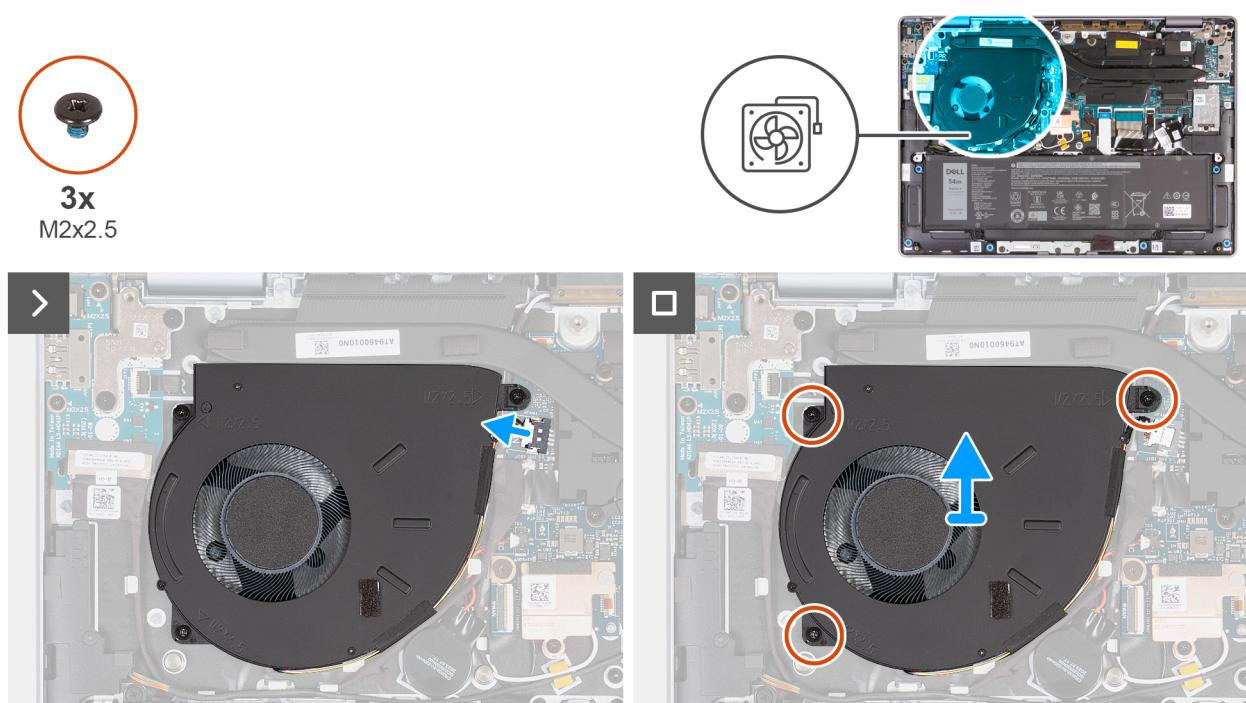
**Obrázek 35. Demontáž ventilátoru (pro počítače dodávané pouze s podporou sítě WLAN)**
