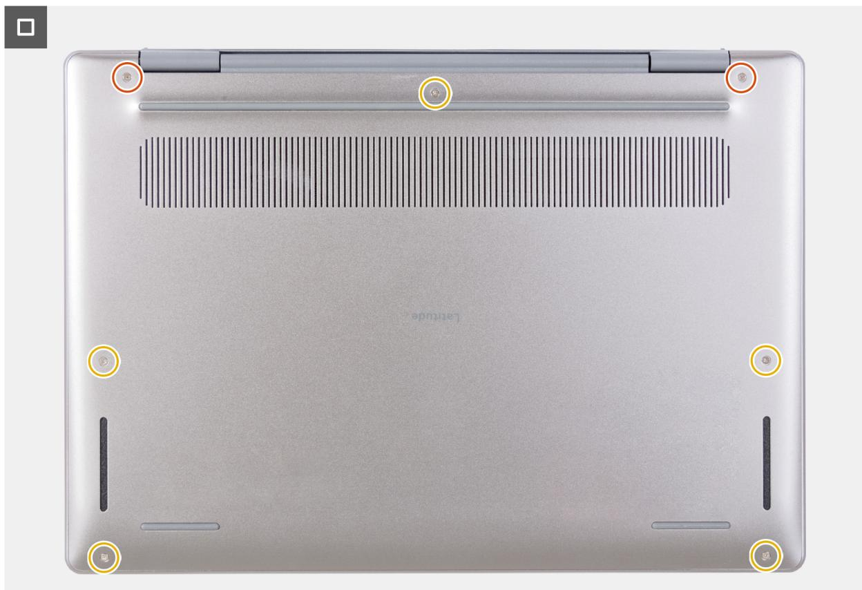
Obrázek 20. Zašroubování a utažení šroubů
