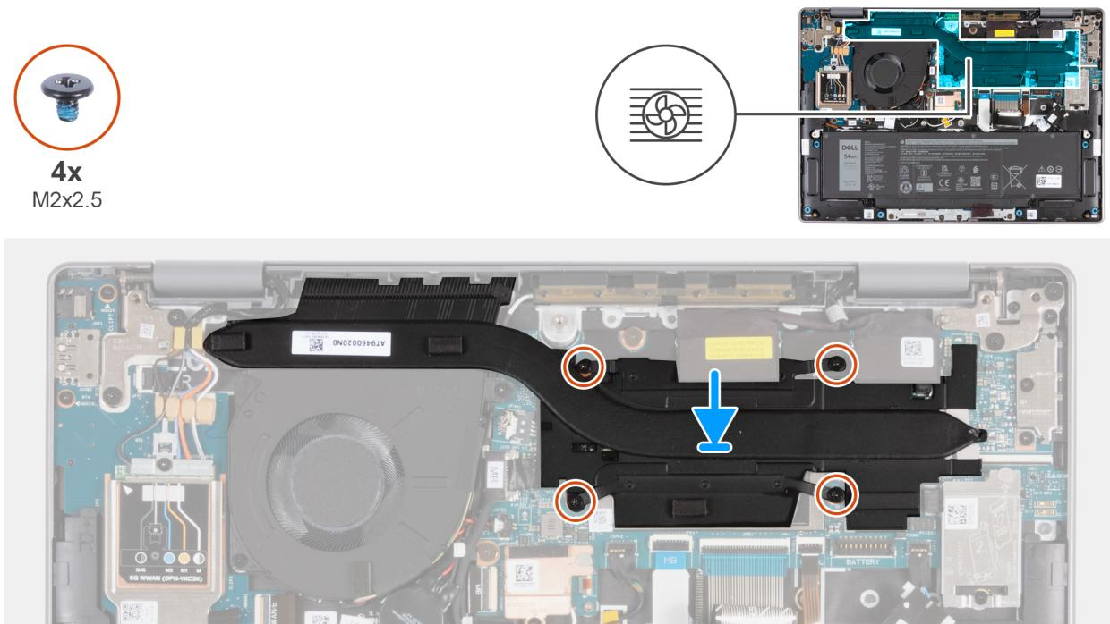
**Obrázek 45. Montáž chladiče**
