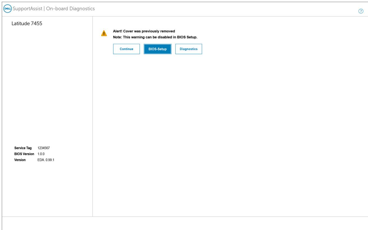
Obrázek 104. Vymazání upozornění při vniknutí do šasi
