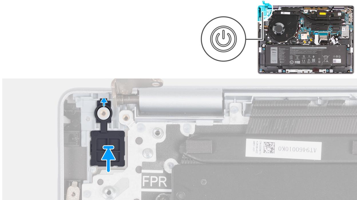
**Obrázek 90. Montáž vypínače**
