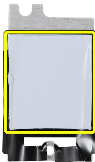
**Obrázek 22. Teplovodivá podložka pod tepelným krytem SSD**
