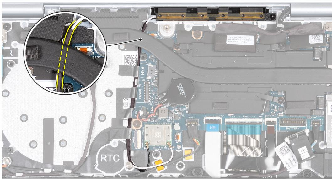
Obrázek 68. Vyjmutí kabelů antény WLAN
