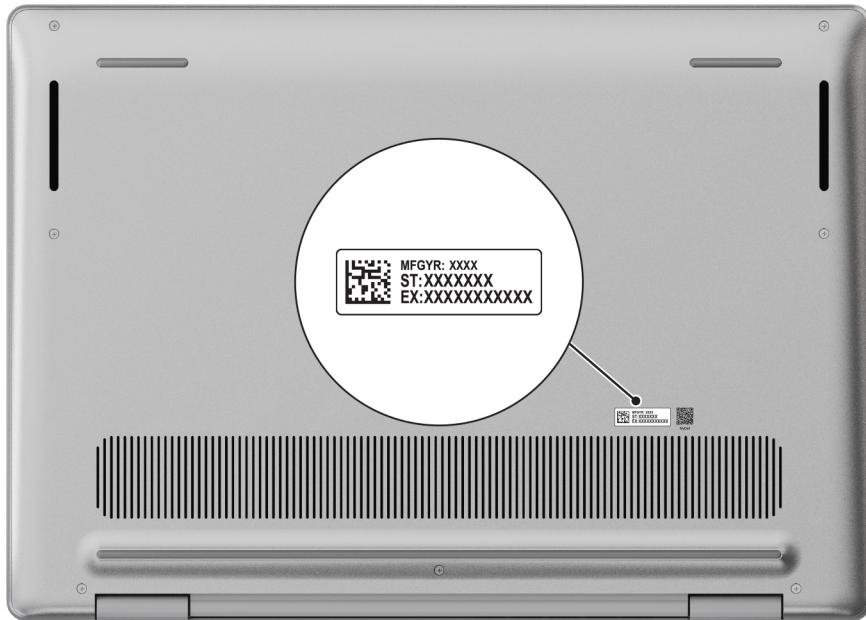
**Obrázek 6. Umístění výrobního čísla / kódu Express Service Code**
