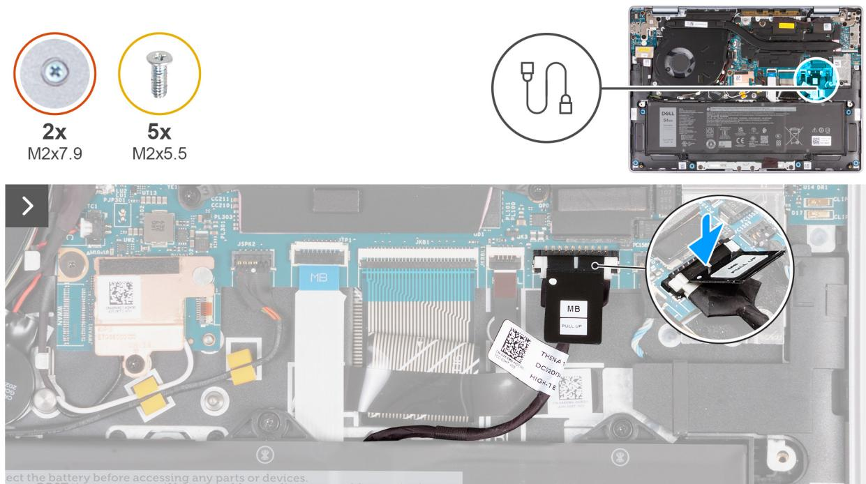
Obrázek 18. Připojení kabelu baterie
