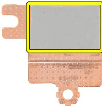
Obrázek 59. Teplovodivá podložka pod tepelným krytem WLAN
