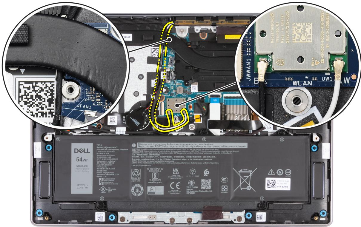
**Obrázek 62. Montáž kabelů antény WLAN**
