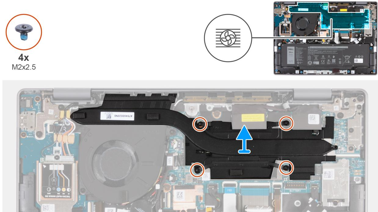
Obrázek 44. Demontáž chladiče
