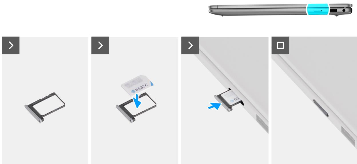
**Obrázek 14. Vložení držáku karty SIM**
