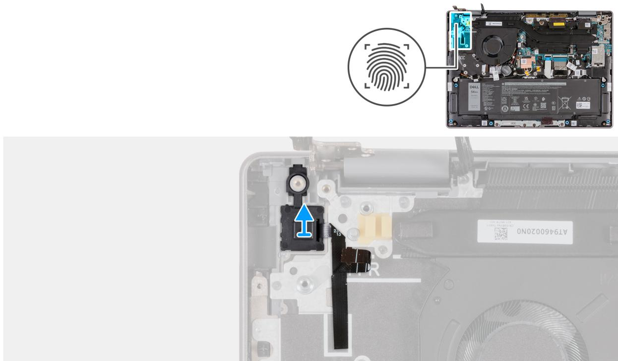
Obrázek 89. Demontáž vypínače se čtečkou otisků prstů
