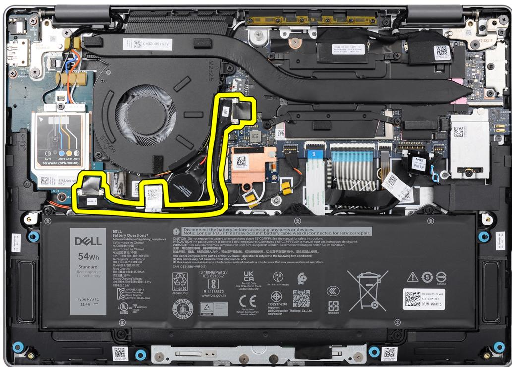
**Obrázek 54. Umístění kabelu desky I/O**
