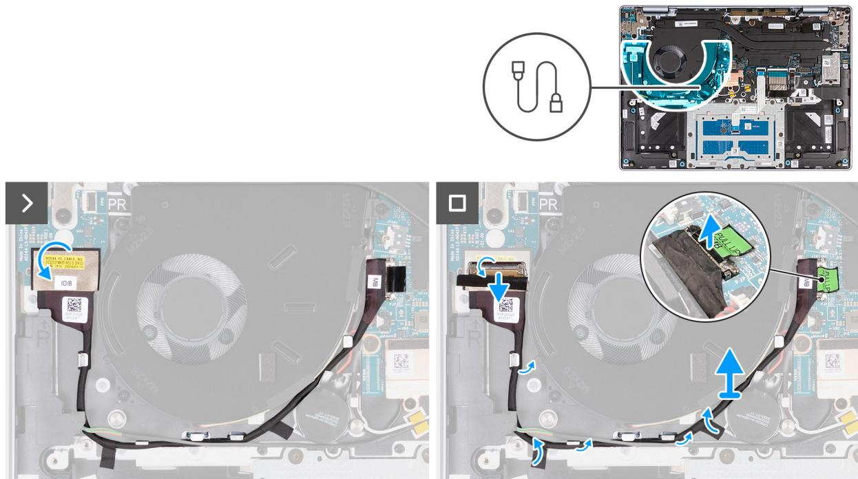
**Obrázek 49. Demontáž kabelu desky I/O (pro počítače dodávané pouze s podporou sítě WLAN)**
