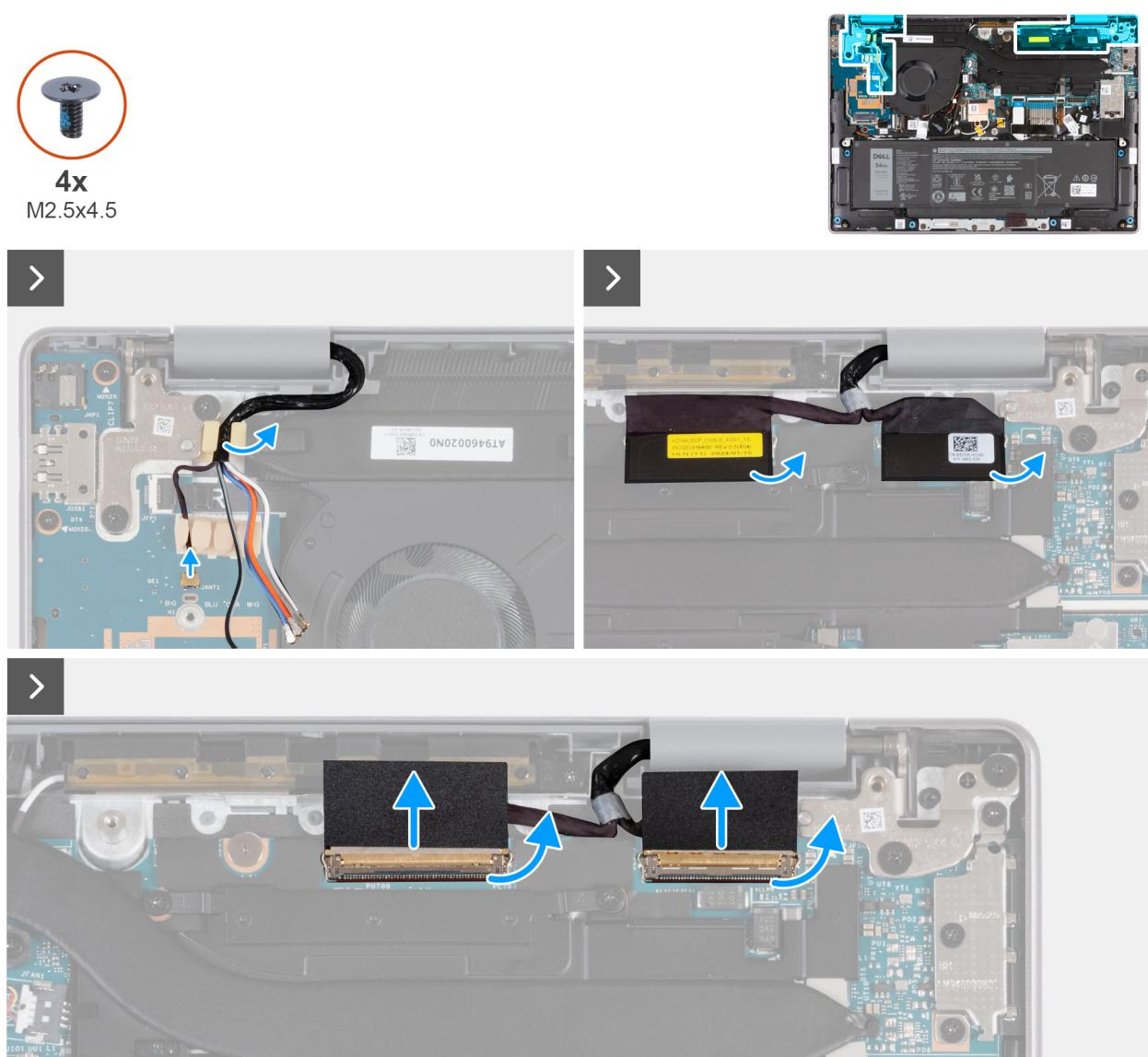
Obrázek 77. Demontáž sestavy displeje (pro počítače dodávané s podporou sítě WWAN)
