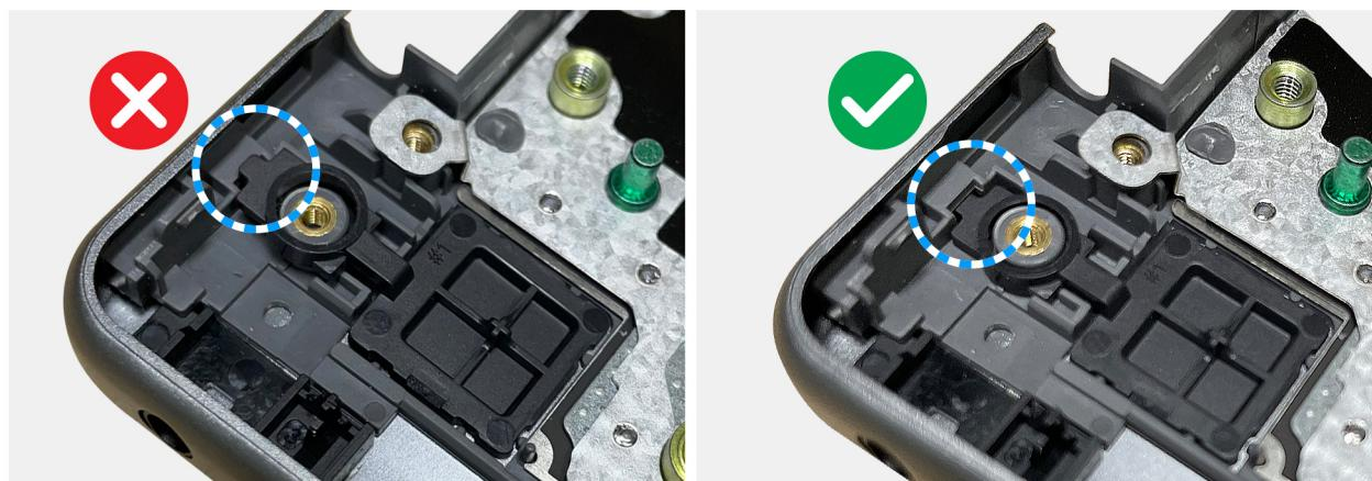
**Obrázek 92. Montáž vypínače**
