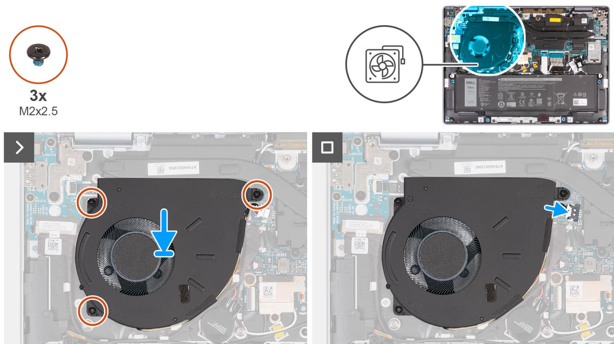
**Obrázek 36. Montáž ventilátoru (pro počítače dodávané pouze s podporou sítě WLAN)**
