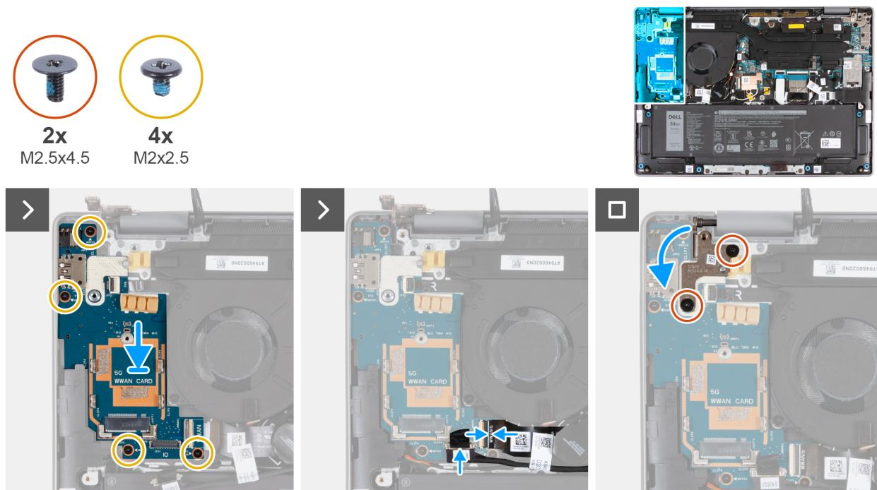
Obrázek 85. Montáž desky I/O, demontáž desky I/O (pro počítače dodávané s podporou sítě WWAN)
