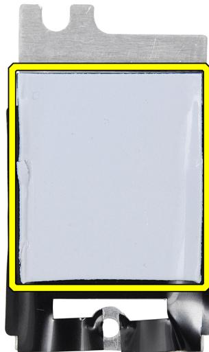
Obrázek 25. Teplovodivá podložka pod tepelným krytem SSD
