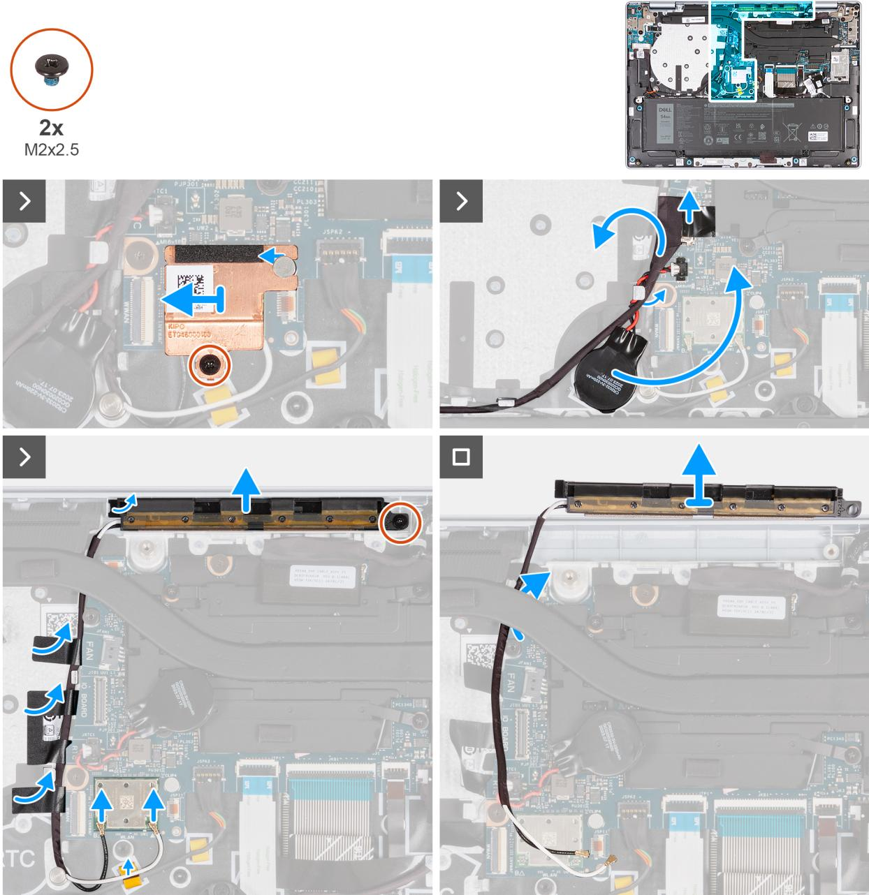
**Obrázek 58. Demontáž modulu antény WLAN (pro počítače dodávané pouze s podporou sítě WLAN)**
