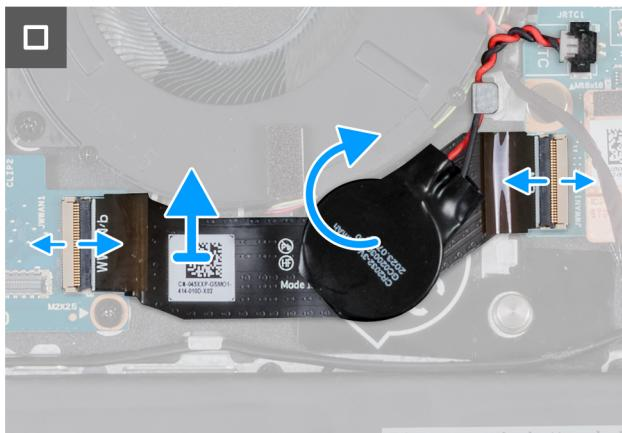
Obrázek 56. Demontáž kabelu FPC desky I/O
