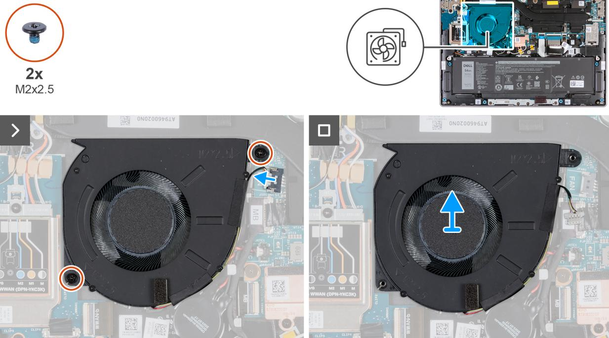
**Obrázek 37. Demontáž ventilátoru (pro počítače dodávané s podporou sítě WWAN)**
