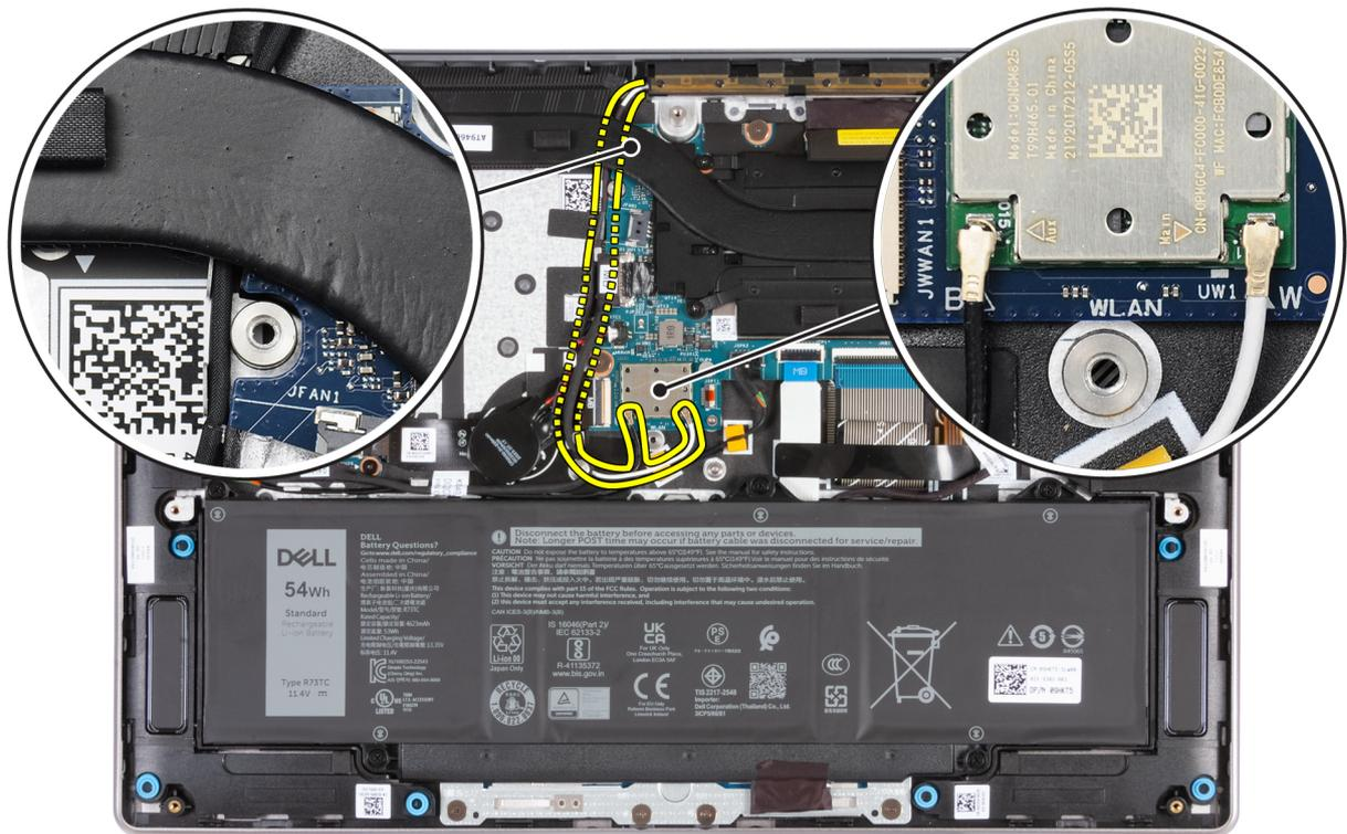
Abbildung 71. Installieren der WLAN-Antennenkabel
