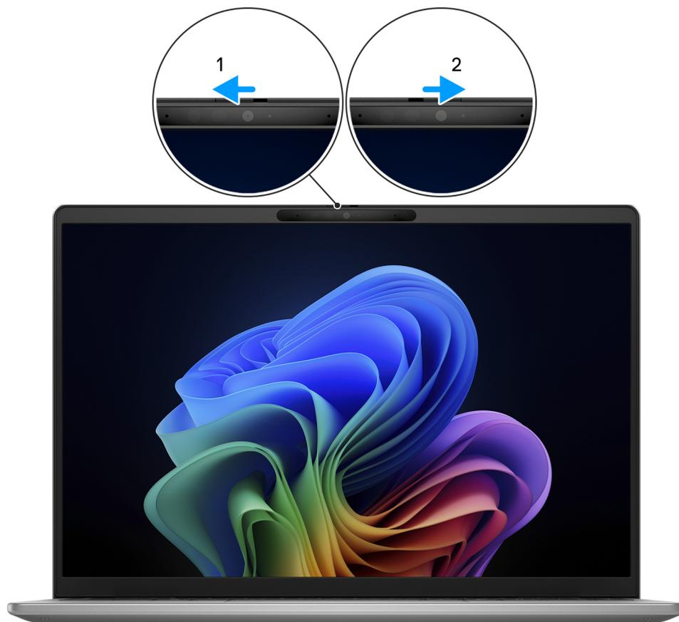
Abbildung 8. Verwenden der Kameraabdeckung
