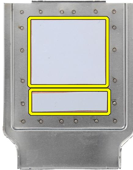
Abbildung 27. Wärmeleitpads an der Unterseite der WWAN-Kühlabdeckung
