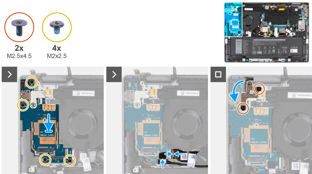
Figure 85. Installation de la carte d'E/S Retrait de la carte d'E/S (pour les ordinateurs expédiés avec une prise en charge WWAN)
