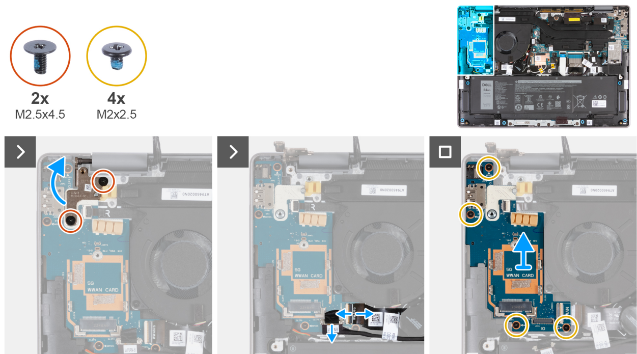
Figure 84. Retrait de la carte d'E/S (pour les ordinateurs expédiés avec une prise en charge WWAN)
