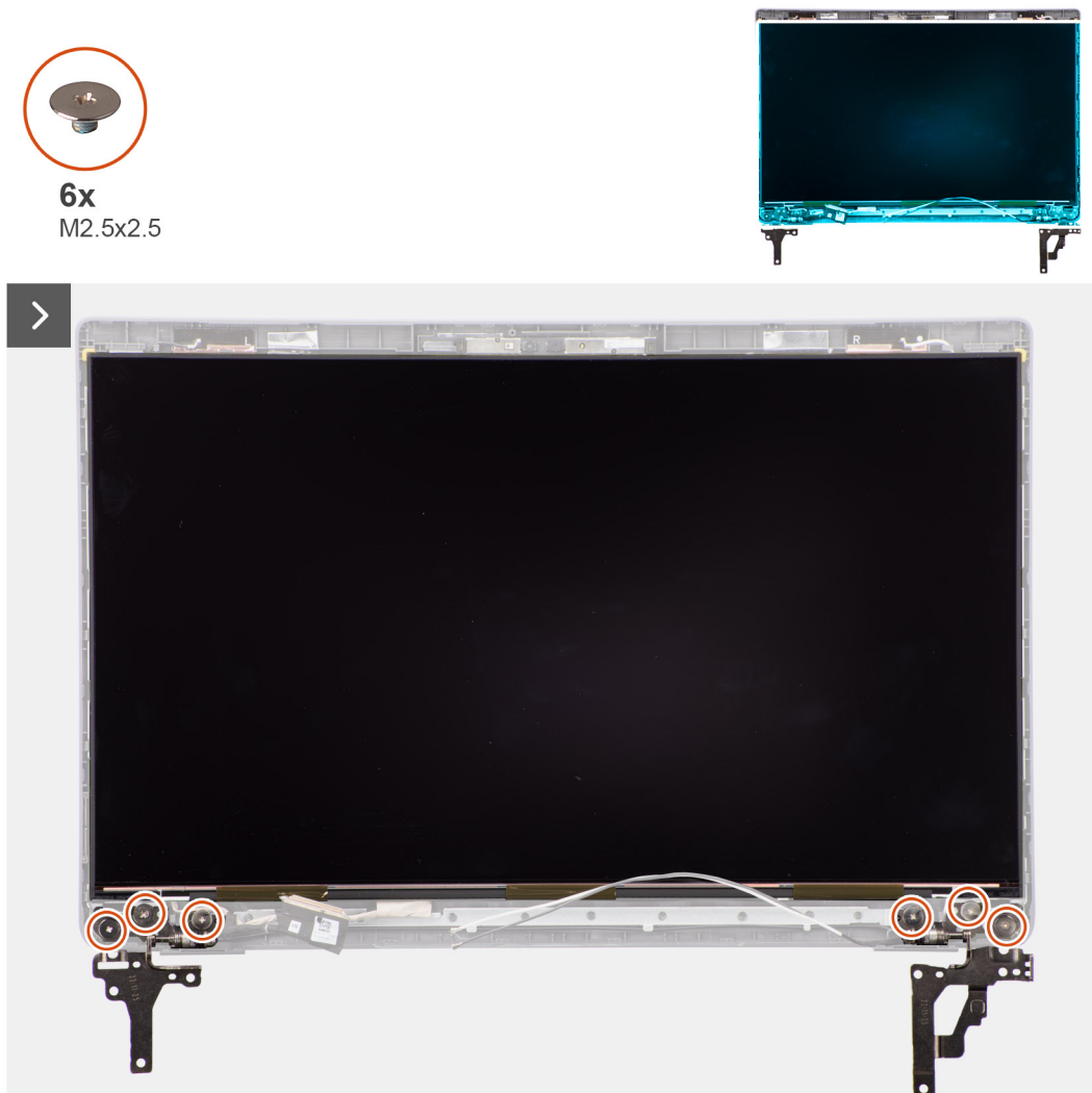
Afbeelding 56. Het beeldschermpaneel verwijderen
