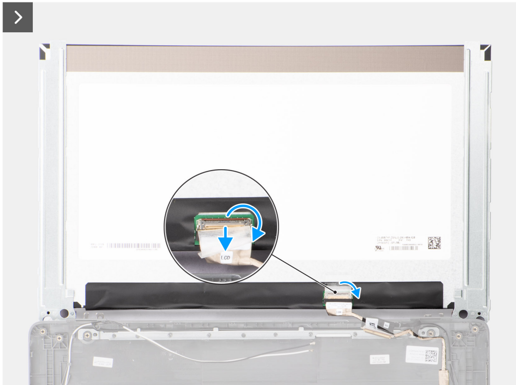
Afbeelding 59. Het beeldschermpaneel verwijderen
