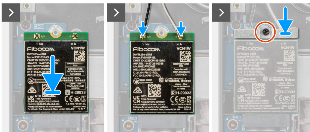
Afbeelding 17. De WWAN-kaart installeren
