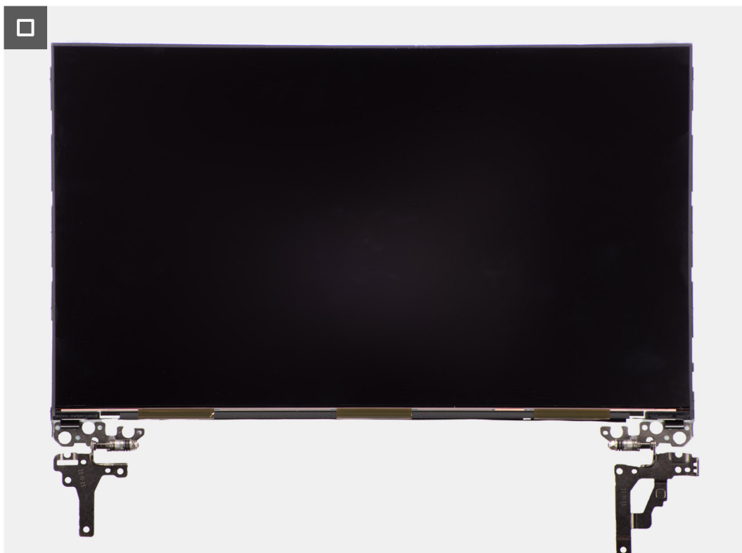
Afbeelding 60. Het beeldschermpaneel verwijderen
