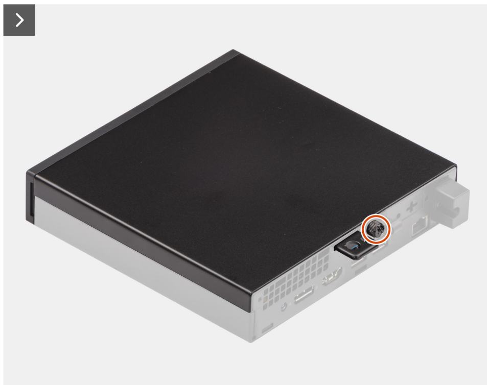
Abbildung 9. Entfernen der Seitenabdeckung
