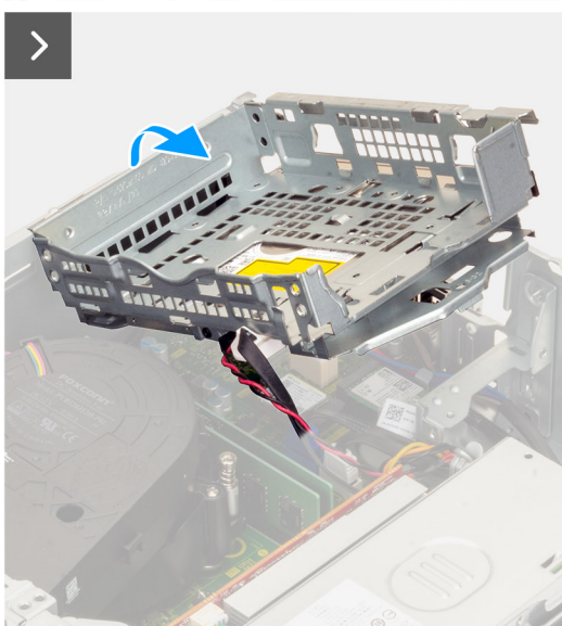
Obrázek 11. Demontáž klece pevného disku.
