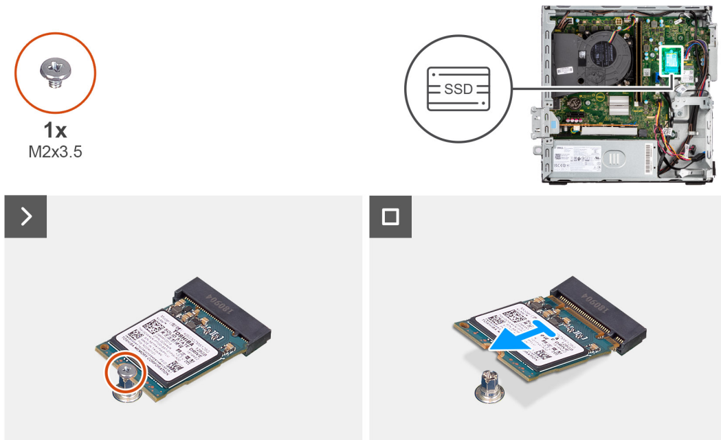
Afbeelding 17. De M.2 2230 SSD verwijderen
