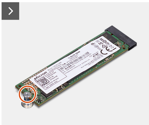
Afbeelding 19. De M.2 2280 SSD verwijderen
