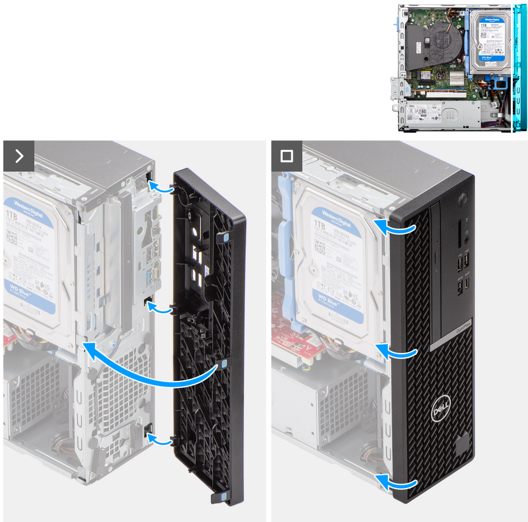
Figure 8. Installation du panneau avant
