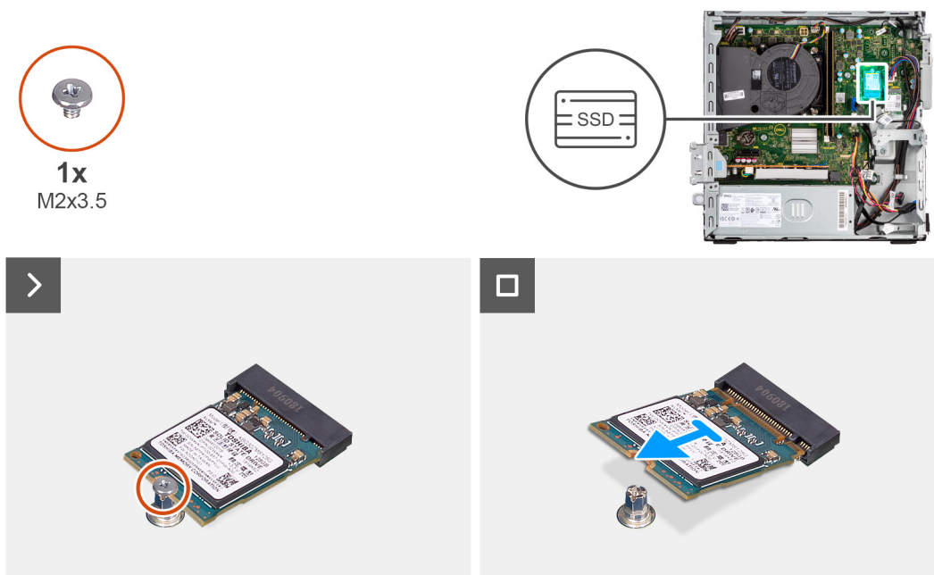
Figure 17. Retrait du disque SSD M.2 2230
