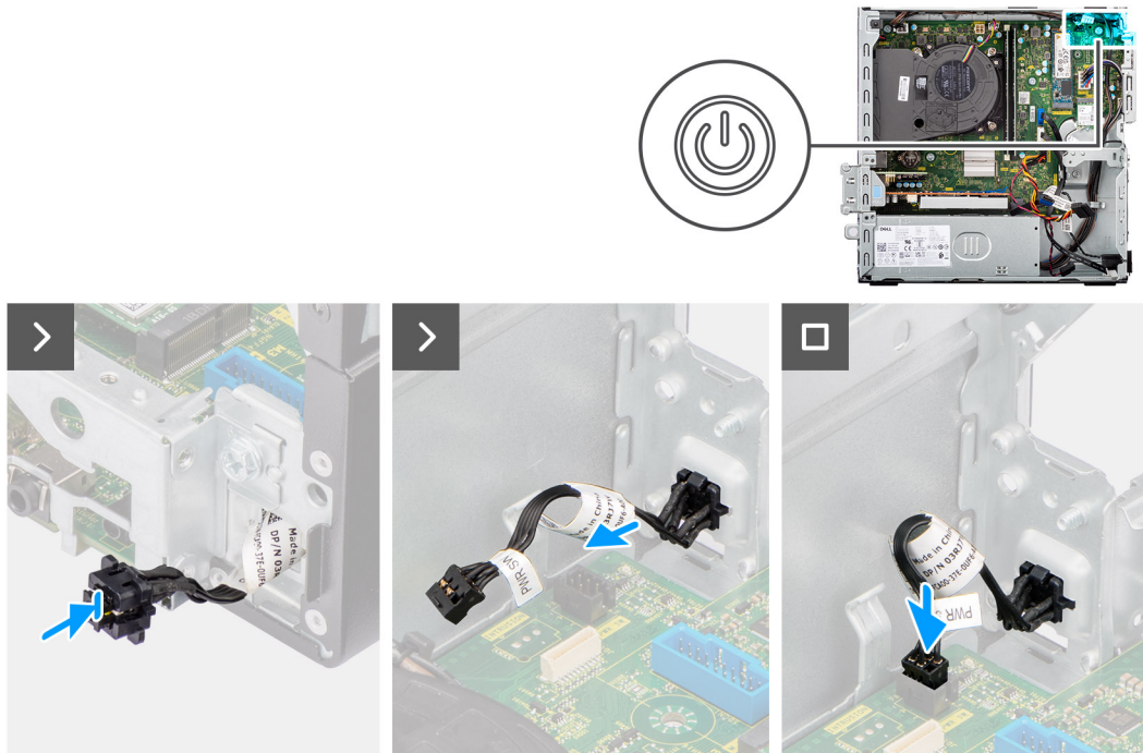
Abbildung 36. Einbauen des Netzschalters
