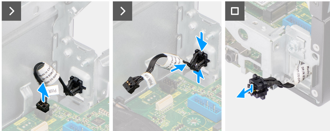
Abbildung 35. Entfernen des Netzschalters
