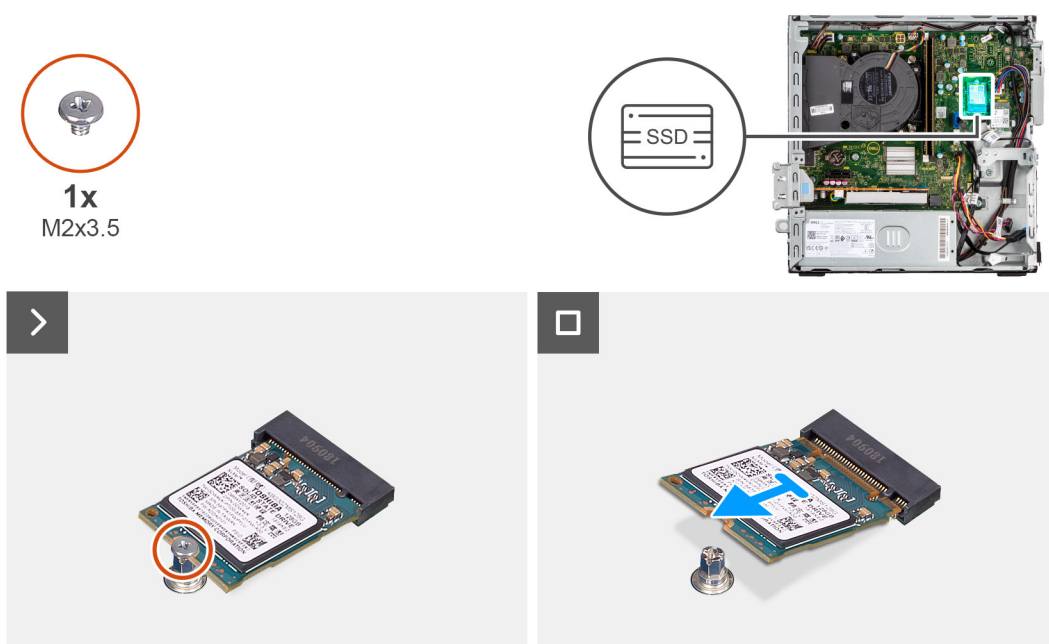
Abbildung 17. Entfernen des M.2-2230-Solid-State-Laufwerks
