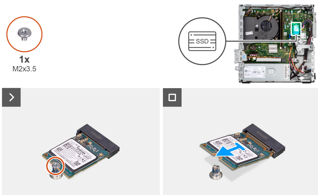
Abbildung 17. Entfernen des M.2-2230-Solid-State-Laufwerks
