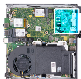
איור 36. התקנת מודול הקלט/פלט האופציונלי (HDMI, DP או PS2)
