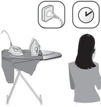
2 當產品在底盤上休息超過 30 秒鐘，或直立放置超過 8 分鐘時，產品將進入自動斷電模式。
