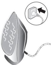
**12** Anslut apparaten igen och låt den värmas upp så att stryksulan torkar. Detta tar ungefär 2 minuter.
