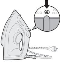
3 將蒸氣控制鈕向右滑動，即可選擇無蒸氣模式 (乾式熨燙)
