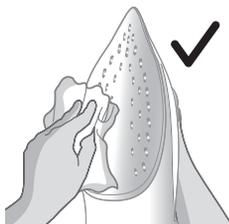
3 Wytrzyj osad ze stopy wilgotną ściereczką.
