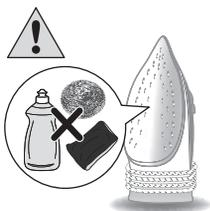
Примечание. Для поддержания гладкой поверхности подошвы избегайте контакта жестких вещей с металлическими объектами. Не используйте металлическую губку, уксус и другие химикаты для очистки подошвы.
