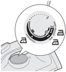
2 將溫度控制轉鈕轉到適當的溫度指示，以設定所需的熨燙溫度。
