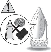
Lưu ý: Để giữ mặt đế bàn ủi trơn nhẵn, tránh va chạm mạnh với các đồ vật kim loại. Tuyệt đối không sử dụng miếng cọ rửa, giấm hoặc các hóa chất khác để làm sạch mặt đế.
