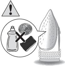
注意：为了保持底板光滑，请避免与金属物体发生硬接触。切勿使用钢丝绒、醋或其他化学品清洗底板。
