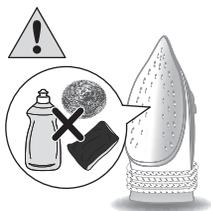
Uwaga: aby stopa żelazka była gładka, należy unikać kontaktu z metalowymi przedmiotami. Nigdy nie używaj ostrych ściereczek, octu ani innych środków chemicznych do czyszczenia stopy żelazka.
