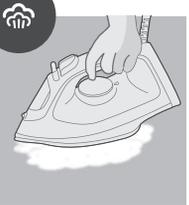
Kaksi höyrypilvettä: Laite tuottaa höyryä suuremmalla teholla vaikeiden ryppyjen poistamiseen.
