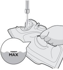
3 将水注入水箱，直至达到最高 (MAX) 水位标识。
