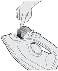
5 将水注入水箱，直至达到最高 (MAX) 水位标识。
