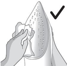
توجه: برای خنثی برداشتن صفحه کف اتو، از تماس فلزات و اشیای سخت با کف اتو خودداری کنید. هرگز از یک پد ساینشی، سرکه یا مواد شیمیایی دیگر برای تمیز کردن صفحه صاف کف اتو استفاده نکنید.
