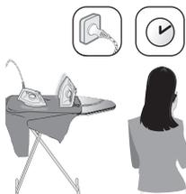
2 اگر دستگاه برای بیشتر از 30 ثانیه روی کف اتو یا بیشتر از 8 دقیقه روی پاشنه بدون استفاده بماند، وارد حالت خاموش شدن خودکار می‌شود.
