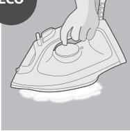
تنظیم ECO: برای لباس‌هایی که چروک کمتری دارند، کمترین میزان بخار به طور ثابت و مداوم تولید می‌شود. این تنظیم در مصرف انرژی صرفه جویی می‌کند.
