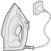
5 Conecte o aparelho a uma tomada de parede aterrada.
