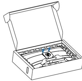
4. Allentare le viti di montaggio, rimuovere la cerniera.
