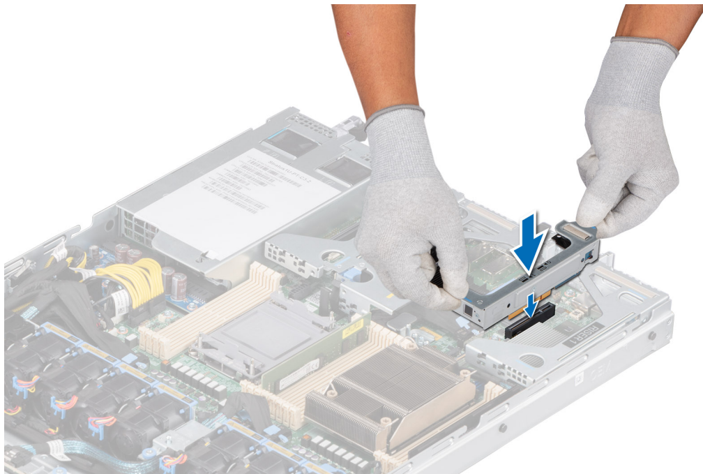
Ilustración 77. Instalación del soporte vertical de Boot Optimized Storage Subsystem M.2
