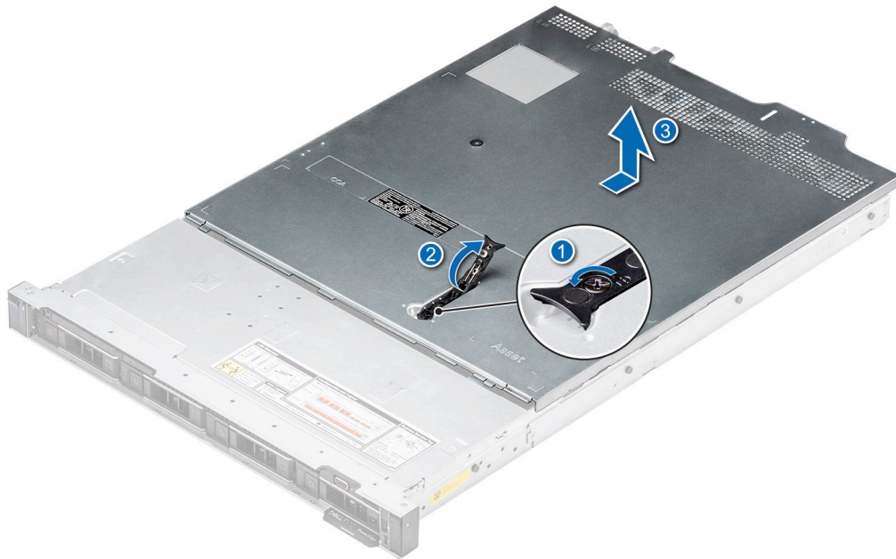
Ilustración 17. Extracción de la cubierta del sistema
