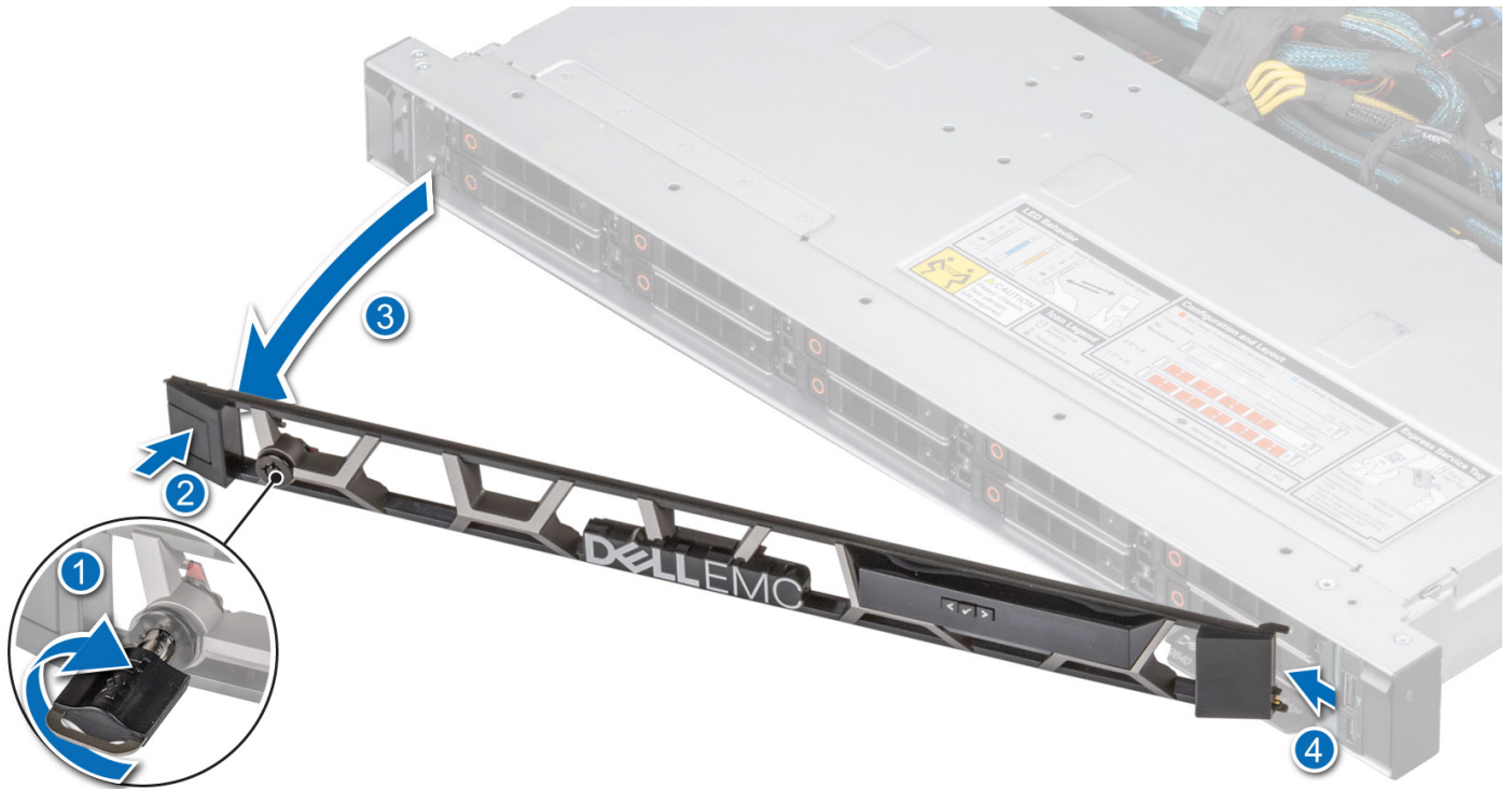
Ilustración 15. Extracción del bisel frontal con el panel LCD
