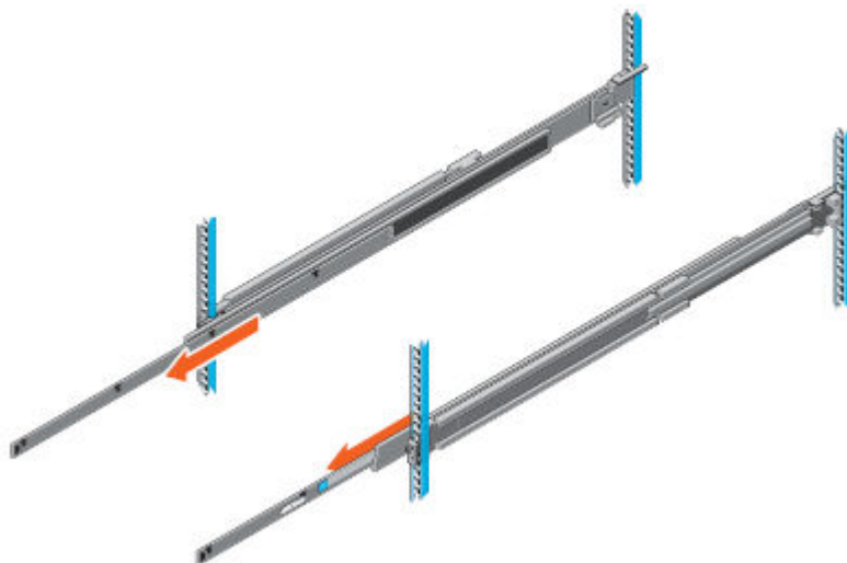
Figura 4 Deslice los rieles internos hacia fuera del gabinete
