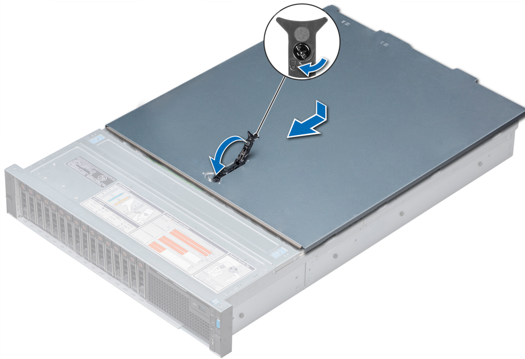
Figura 21 Instalación de la cubierta del sistema
