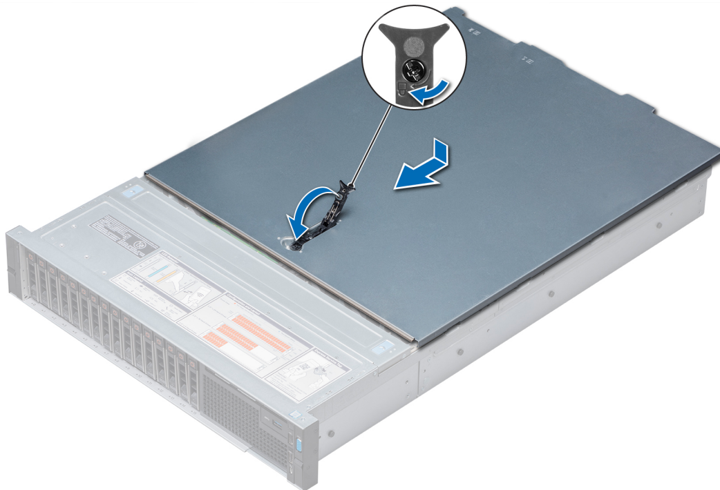
Figura 32 Extracción de la cubierta del sistema
