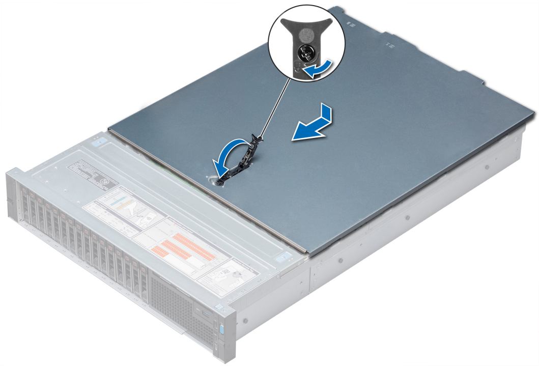
Figura 40 Extracción de la cubierta del sistema
