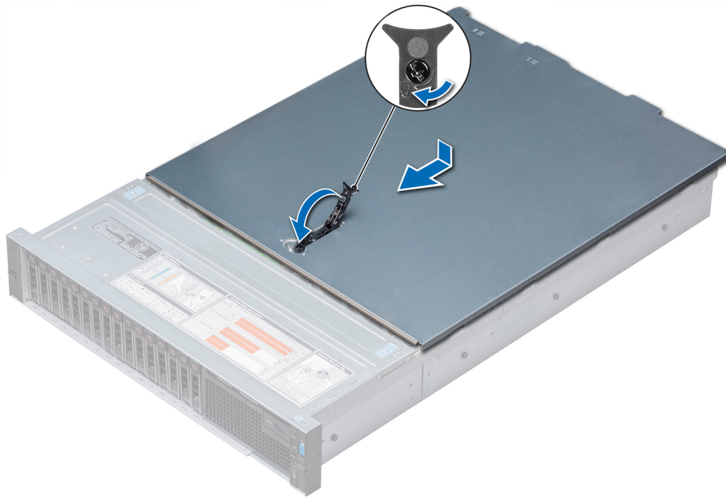
Figura 15 Instalación de la cubierta del sistema
