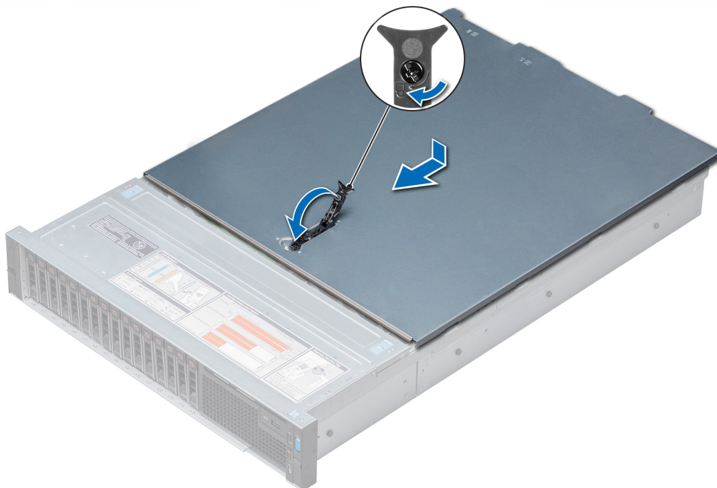
Figura 24 Extracción de la cubierta del sistema
