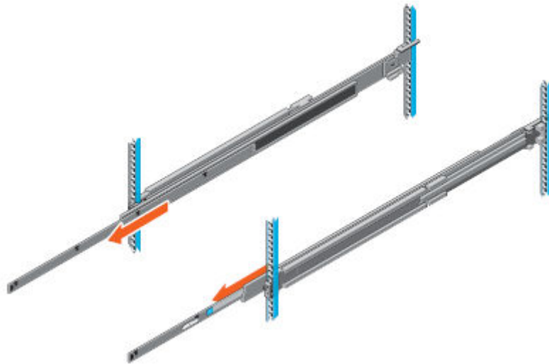
Ilustración 4. Deslice los rieles internos hacia fuera del gabinete
