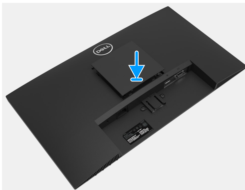
Figura 11. Instalar la cubierta VESA
