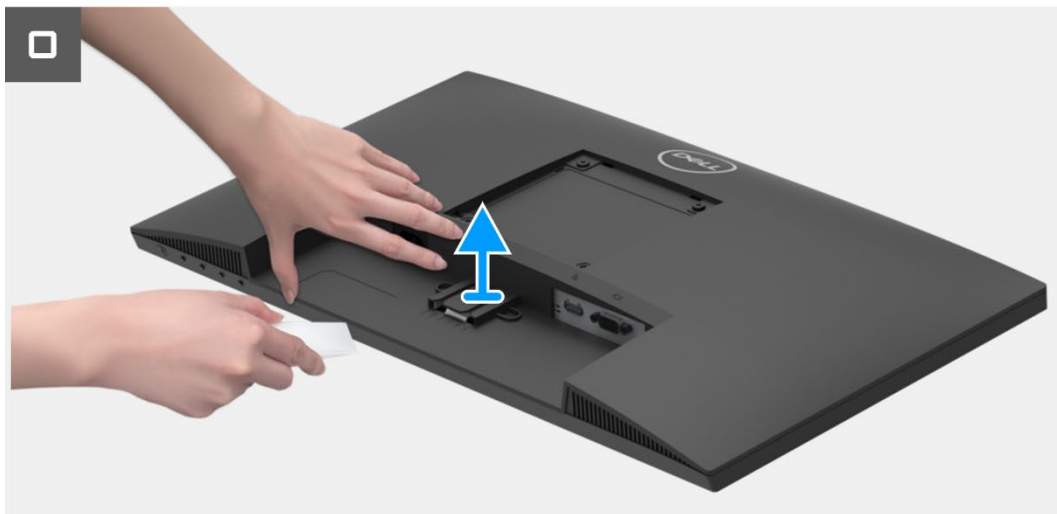
Figura 12. Quitar la cubierta posterior
