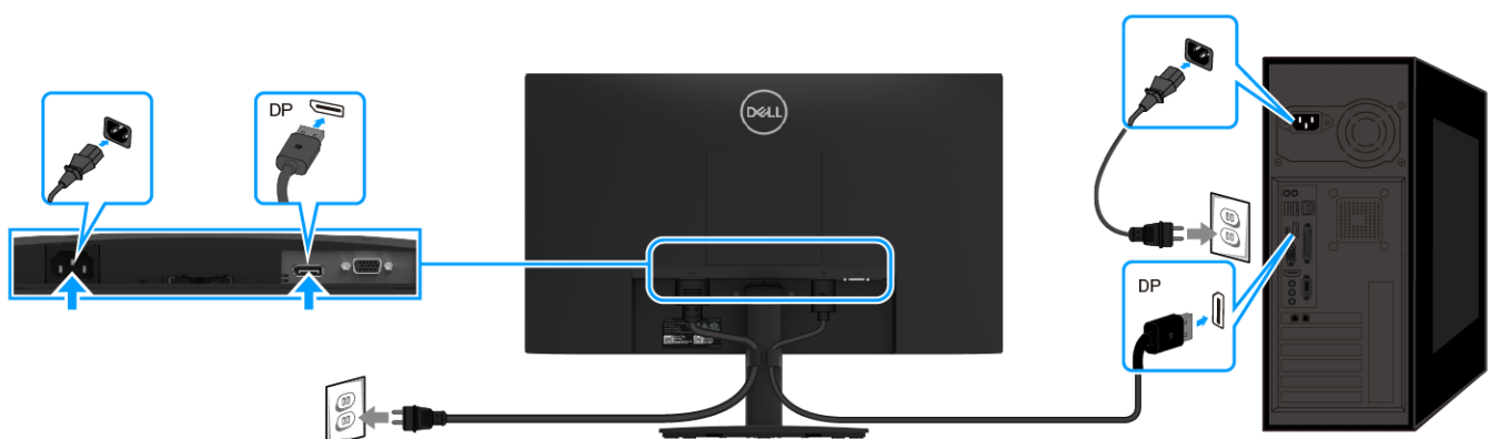
Figura 7. Conectar el cable DP
