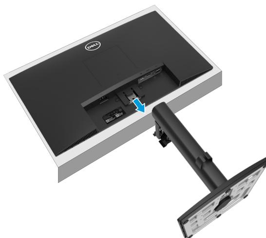
**Figura 28.** Saque el soporte del monitor
