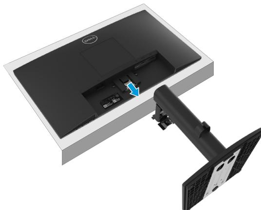
**Figura 25.** Saque el soporte del monitor
