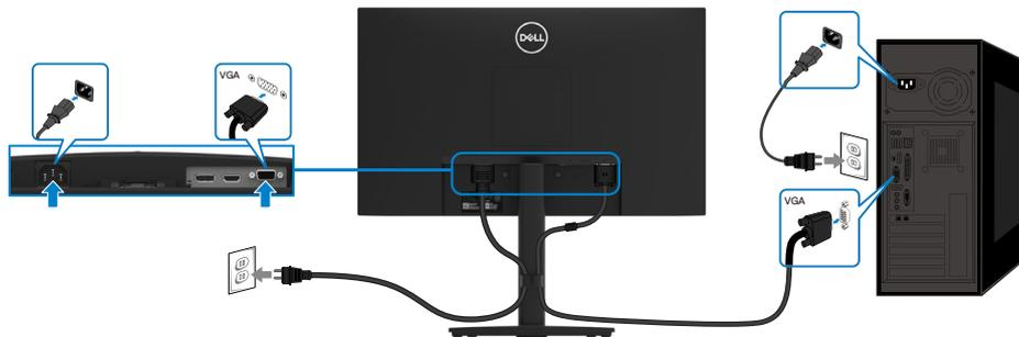
Figura 19. Conectar el cable VGA
