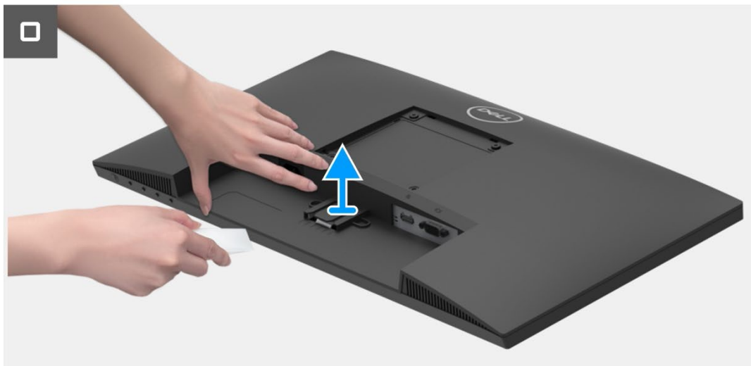
Figure 12. Retrait du couvercle arrière
