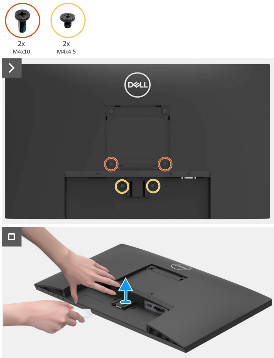
Figura 12. Rimozione del coperchio posteriore
