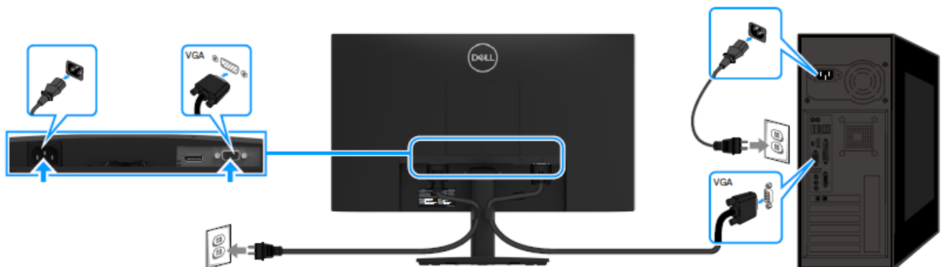
Figura 6. Collegamento del cavo VGA
