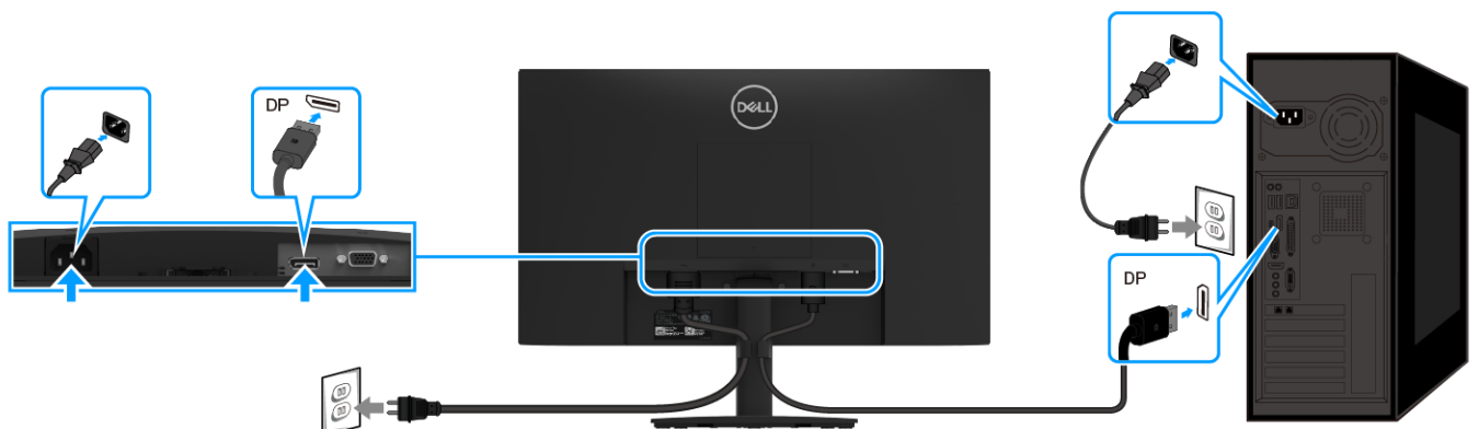
Figura 7. Collegamento del cavo DP
