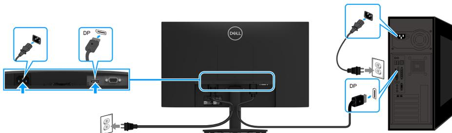
Abbildung 15 DP-Kabel anschließen
