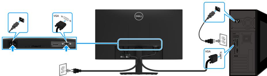
Abbildung 14 VGA-Kabel anschließen
