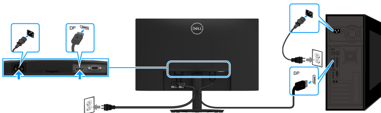
Obrázek 7. Připojení kabelu DP
