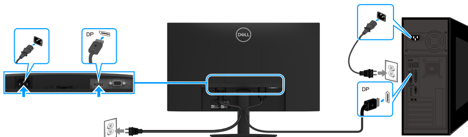
Obrázek 15. Připojení kabelu DP
