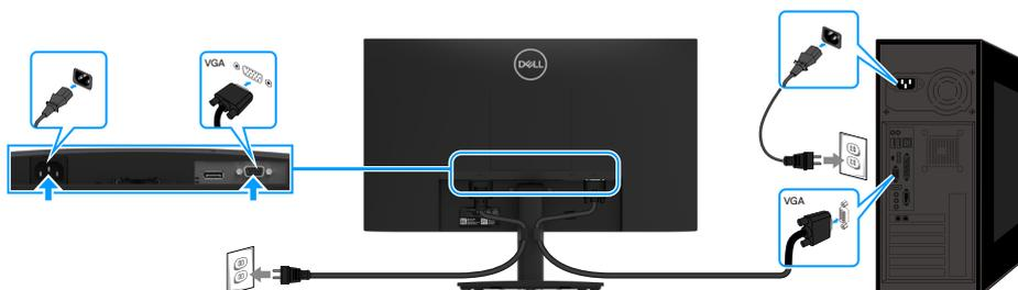
Schéma 14. Branchement du câble VGA
