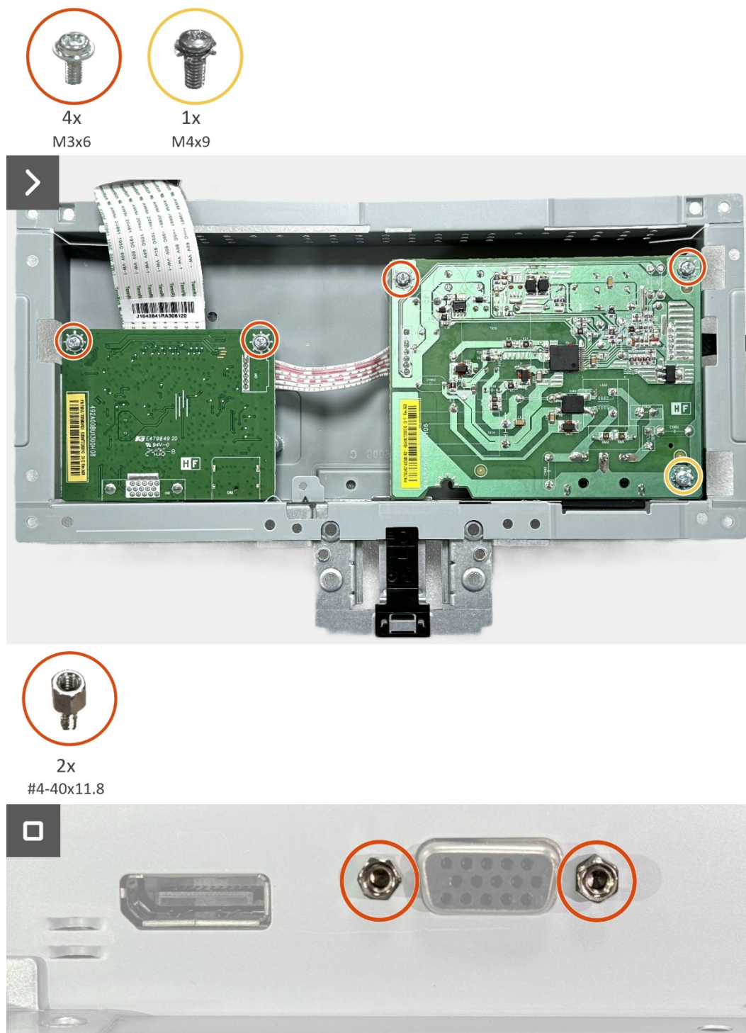
Figura 23. Instalar a placa de interface
