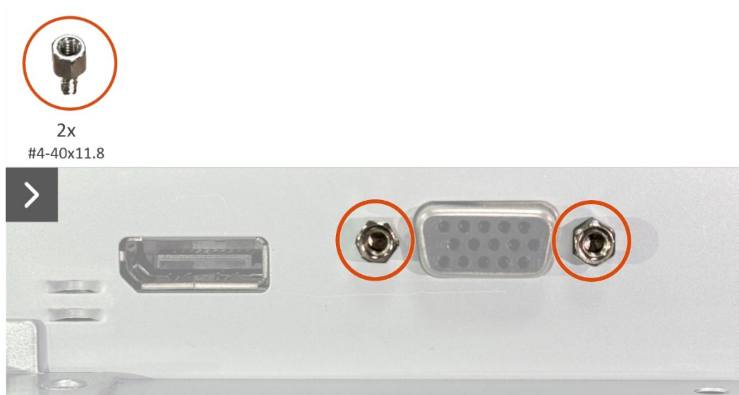
Figura 19. Remover a placa de interface
