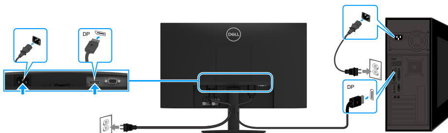
Figura 15. Collegamento del cavo DP
