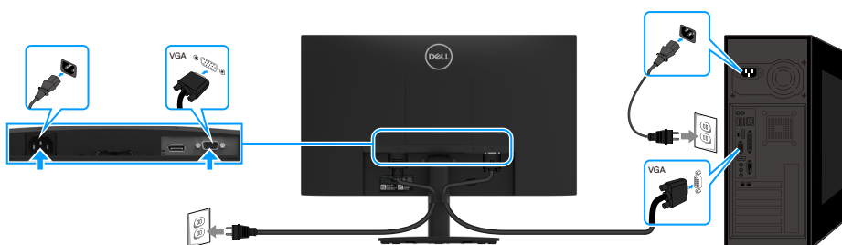
Figura 14. Collegamento del cavo VGA
