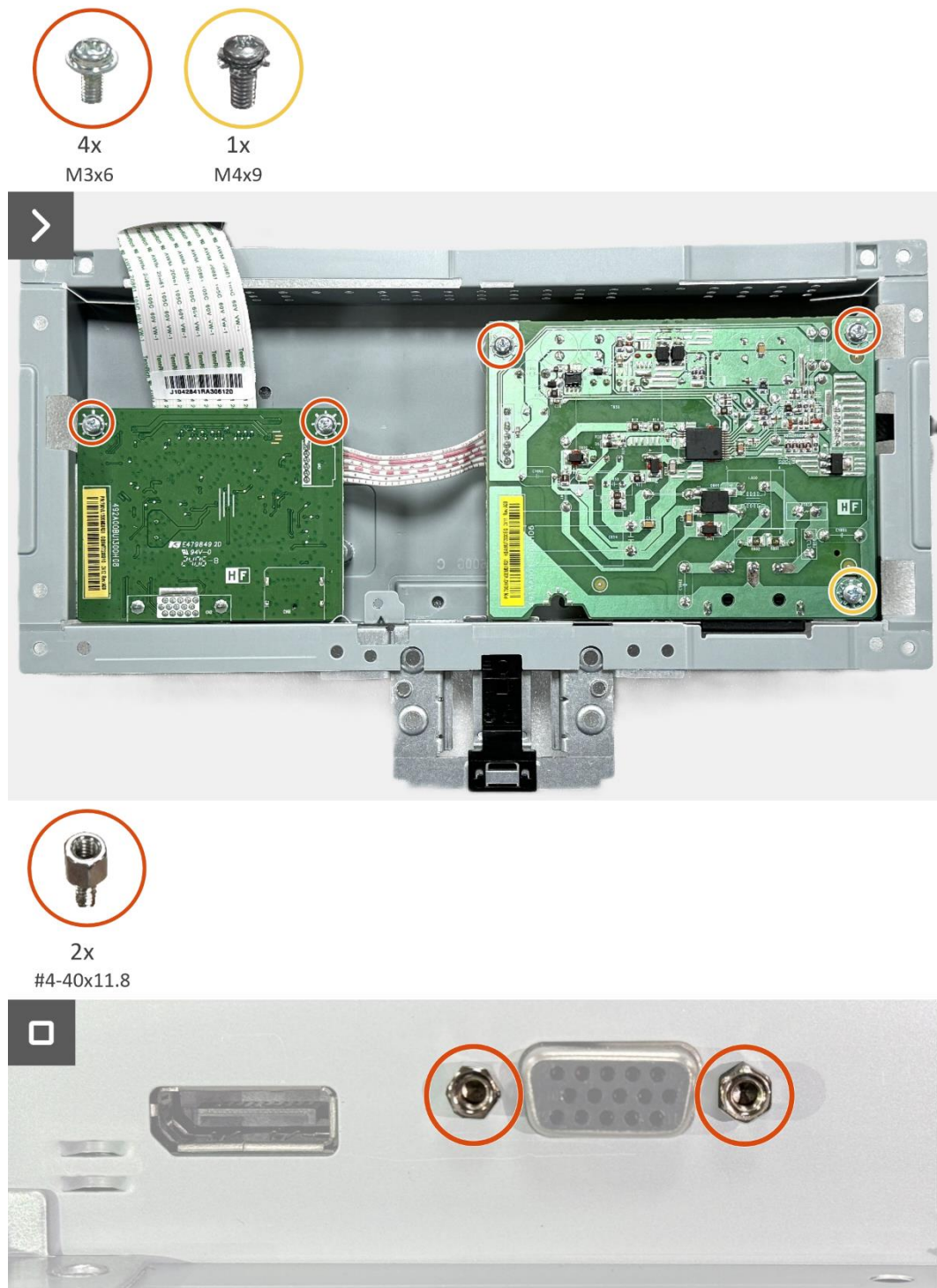
Figura 23. Installazione della scheda di interfaccia
