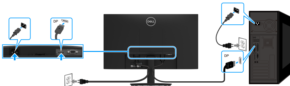
Figura 15. Conectar el cable DP
