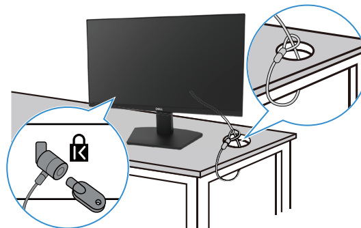
Figura 17. Usar el bloqueo Kensington
