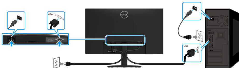
Figura 14. Conectar el cable VGA
