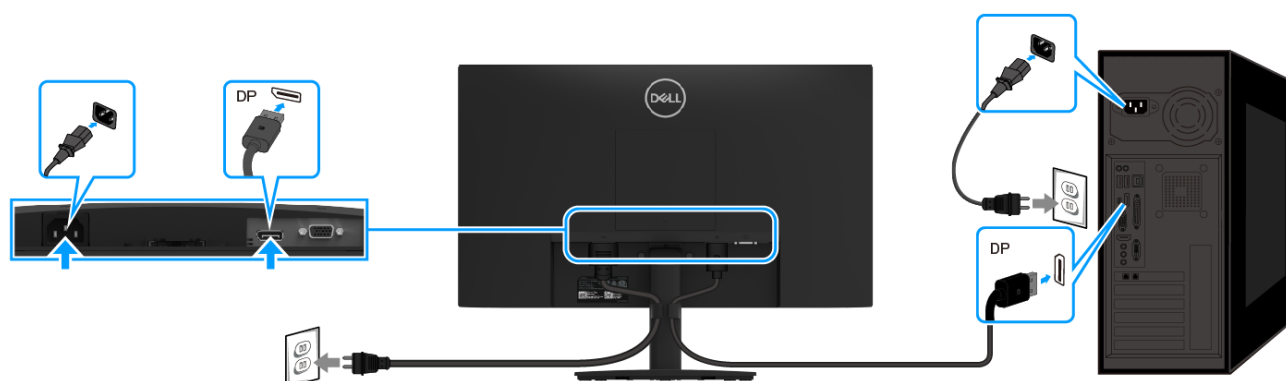
Obrázek 7. Připojení kabelu DP
