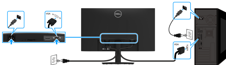
Schéma 14. Branchement du câble VGA
