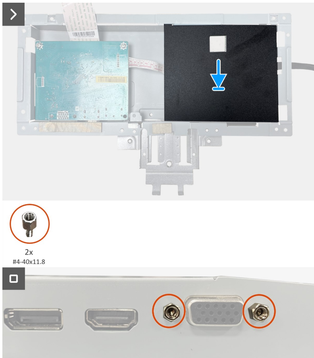
Figura 32. Instalar a placa de interface
