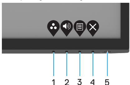
Figura 37. Controlli del pannello frontale
