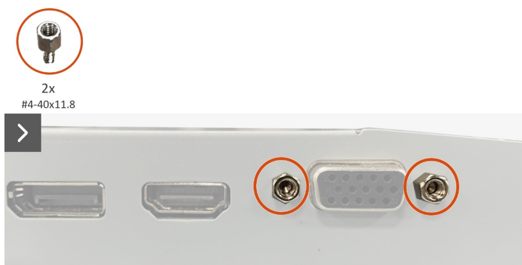
Obrázek 28. Demontáž desky rozhraní
