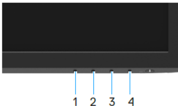
Obrázek 38. Tlačítka funkcí integrované diagnostiky
