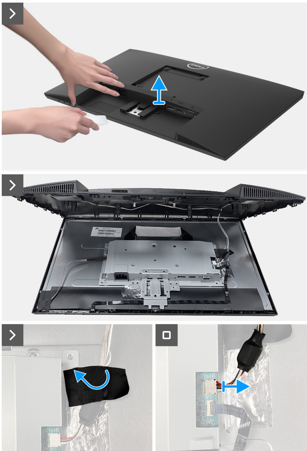
Obrázek 14. Demontáž zadního krytu
