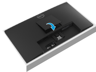
Abbildung 14. Montieren Sie die VESA-Abdeckung
