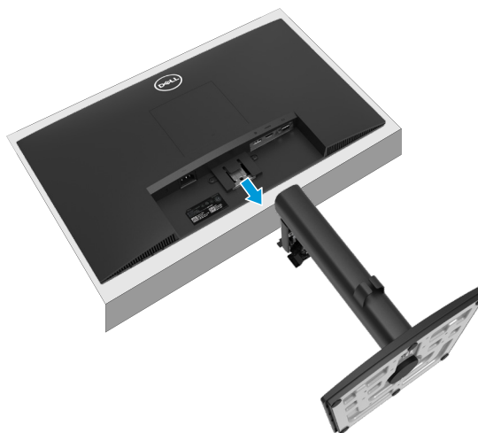
Abbildung 28. Ziehen Sie den Standfuß aus dem Monitor heraus
