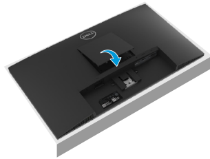
Figure 17. Installer le couvercle VESA
