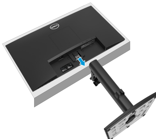
Figure 28. Retirer le support du moniteur
