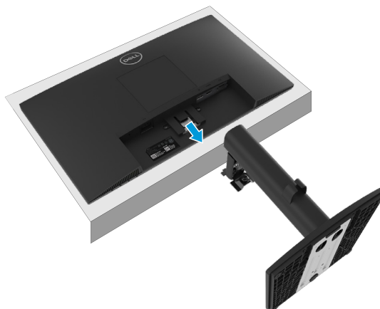
Figure 25. Retirer le support du moniteur
